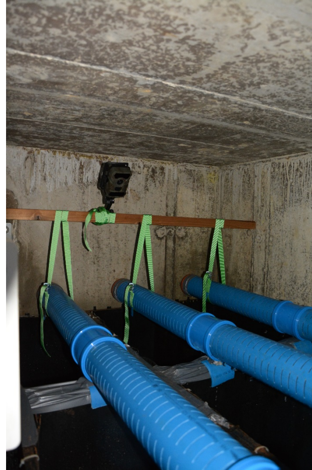
Kamera mit IR-LED-Blitz (bei ca. 940 nm)
