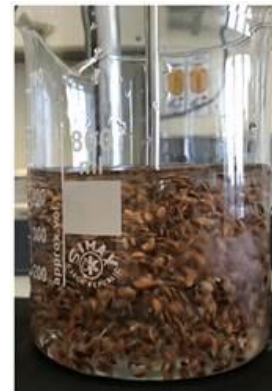
Leinsamen nach Behandlung mit UltraTurrax® und Schneidwerkzeug (links) oder Fundamix® Vibrationsmischer (rechts)
