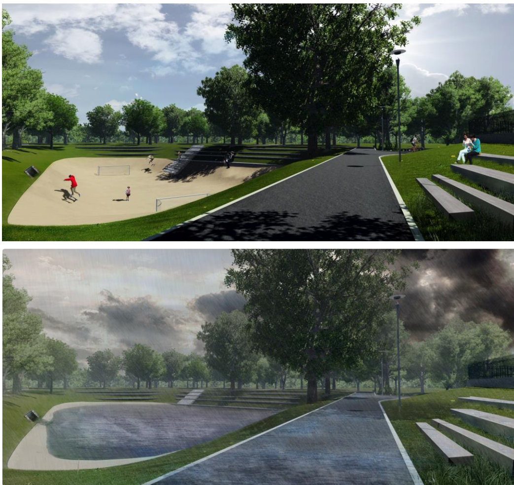
Abbildung 3: Multifunktionaler Retentionsraum für Mischwassernotüberlauf, Fallstudie Wesseling (Quelle: MUST Städtebau)
