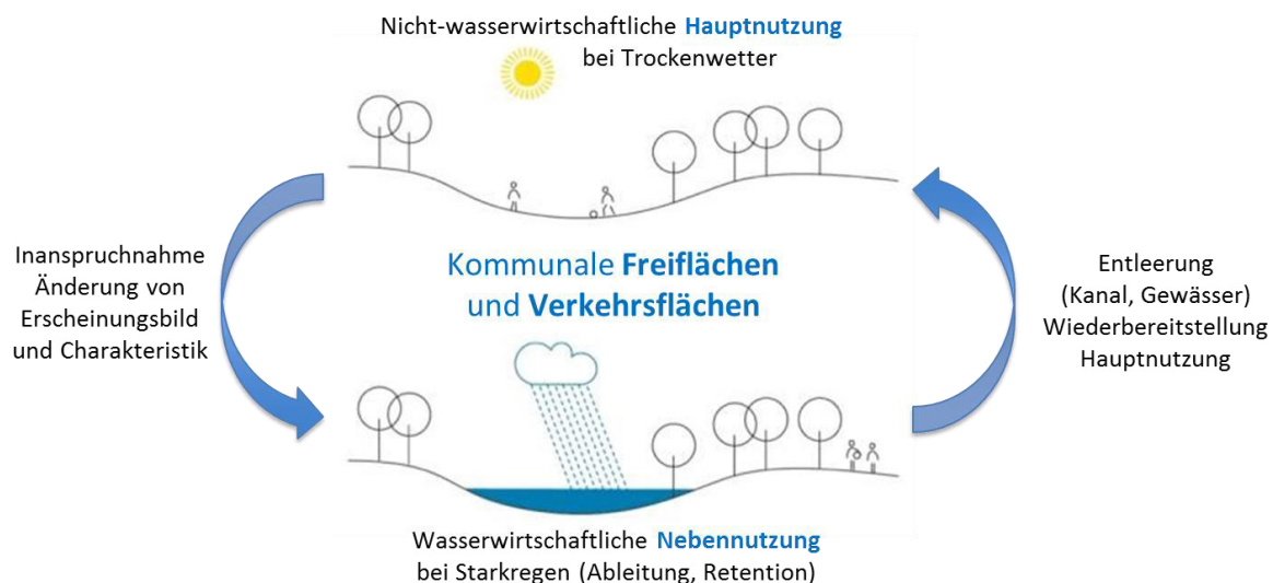
Abbildung 1: Funktionsprinzip eines multifunktionalen urbanen Retentionsraums
