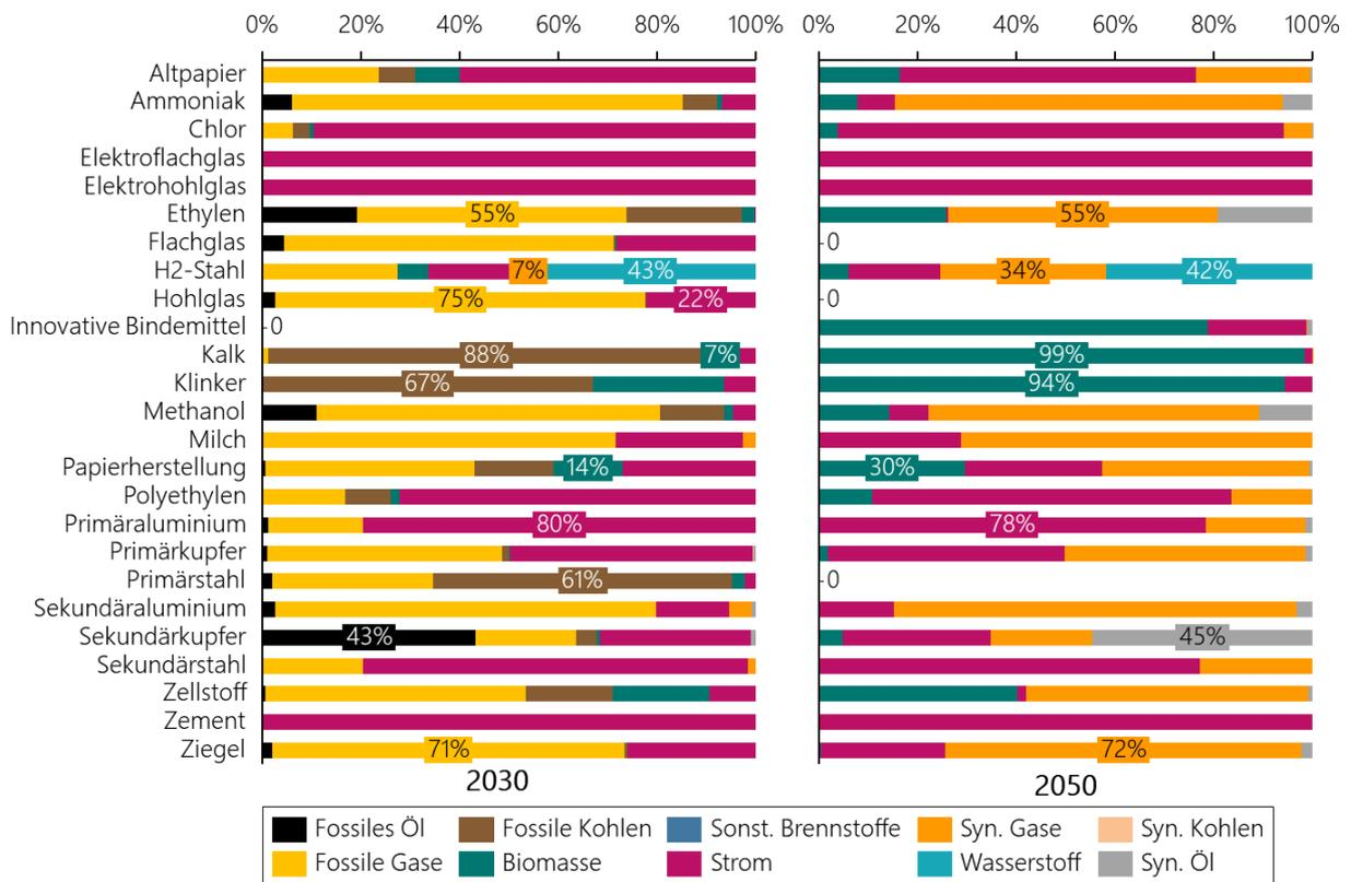
Abbildung 5-3: Optimierter Energieträgermix auf Prozessebene im Technologiemitzenario der Stützjahre 2030 und 2050 im Vergleich
