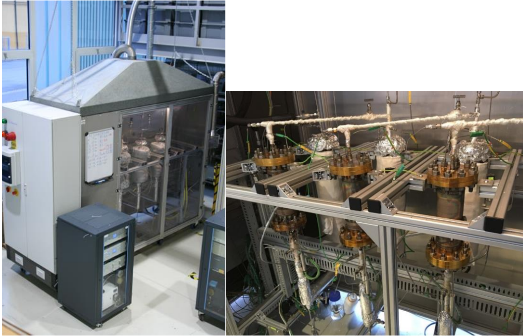
Abbildung 5: Methanisierungsanlage im Technikum des Lehrstuhles für Verfahrenstechnik an der Montanuniversität Leoben
