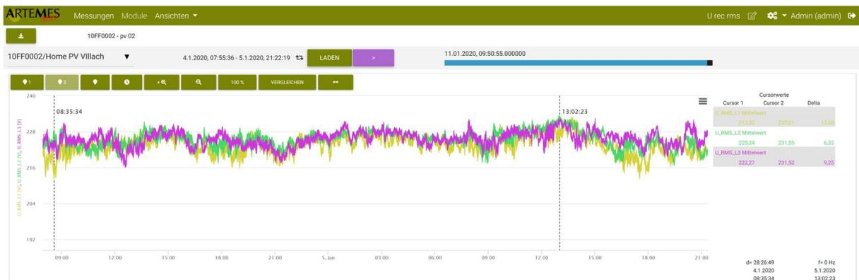
Abbildung 1: Spannungsverlauf am Hausanschluss, PV Wechselrichter 5kW
