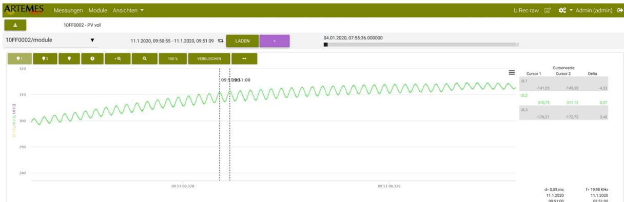
Abbildung 3: Detail am Scheitel des Sinus: ca. 20 kHz Schwingung, wenn der PV Wechselrichter arbeitet
