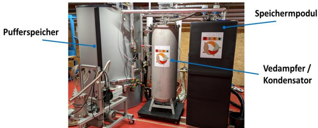
Abbildung 1: Aufbau des saisonalen thermochemischen Solarspeichersystems im Labor
