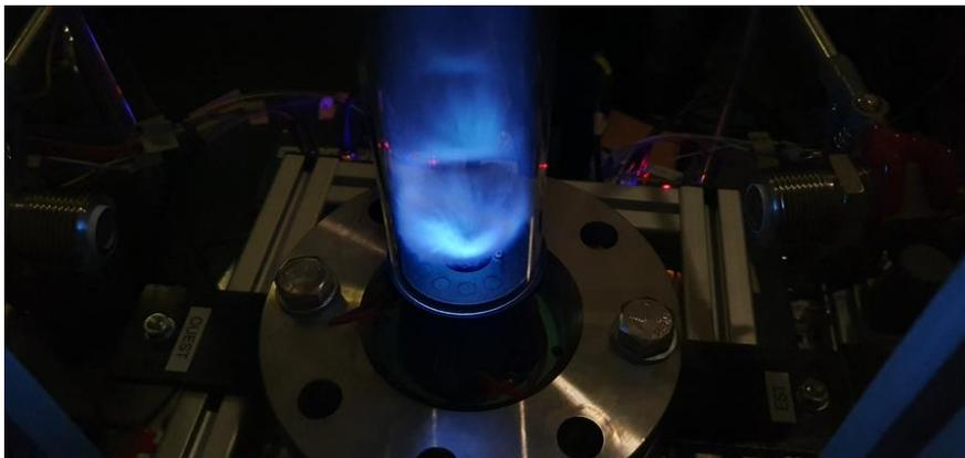
Abbildung 2: Versuchsaufbau und Spektralfarbe einer vorgemischten Flamme
