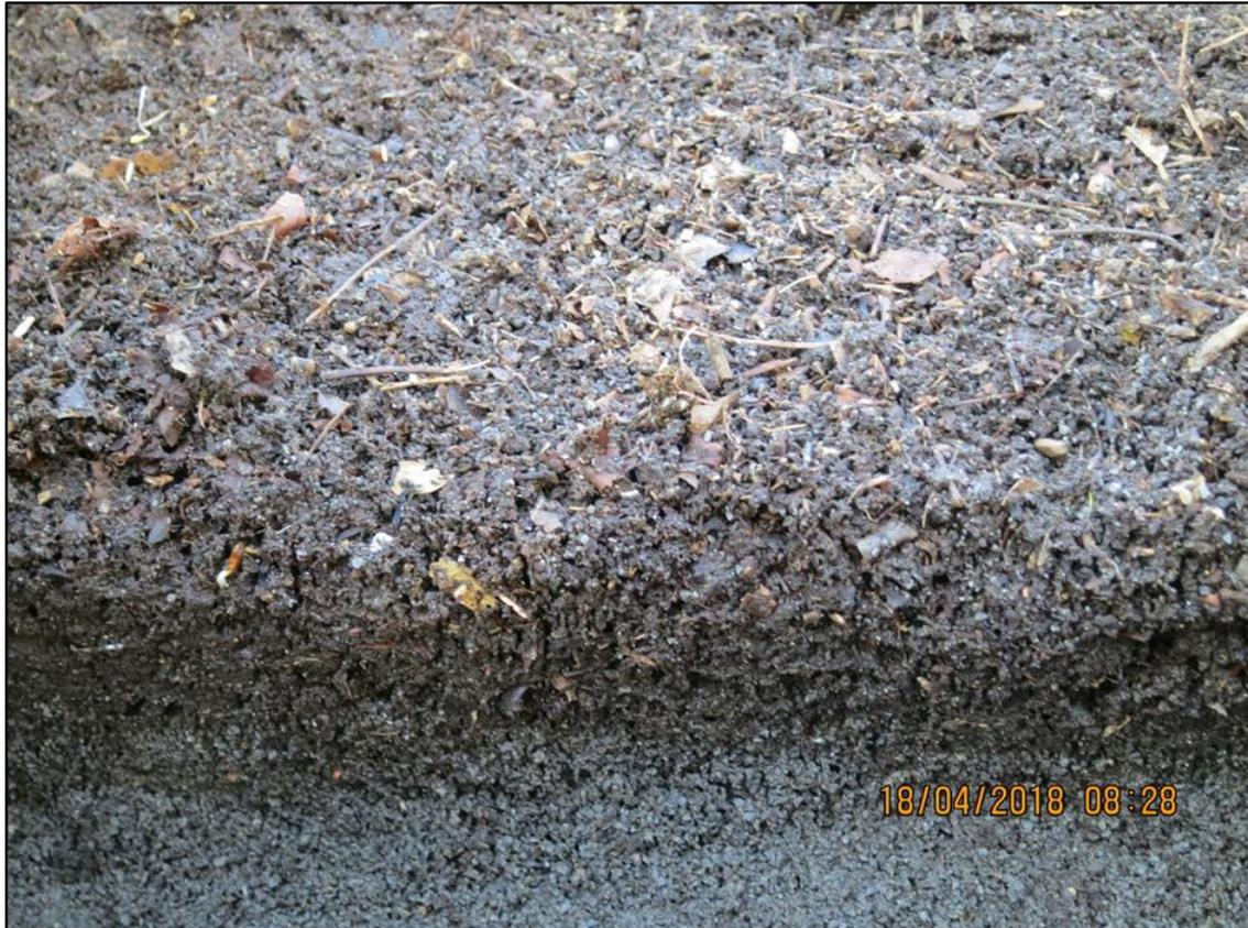
Oben: Schwarze Sekundärfilterschicht mit Feinpartikelaggregation bzw. hoher hydraulischer Filterleistung
