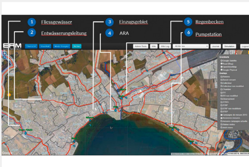
Fig. 5 Die Online-Karte auf der Web-Plattform erm.swissrivers.ch zeigt die Situation im Netz der ERM Morges am 3. Januar 2018 bei starken, prognostizierten Niederschlägen. In der Übersicht sind drei kritische Punkte erkennbar: das Anspringen von 2 Regenüberläufen und das Erreichen der maximalen hydraulischen Kapazität (Warnstufe 2) beim Zufluss zur ARA (Warnstufen durch den Betreiber definiert).
