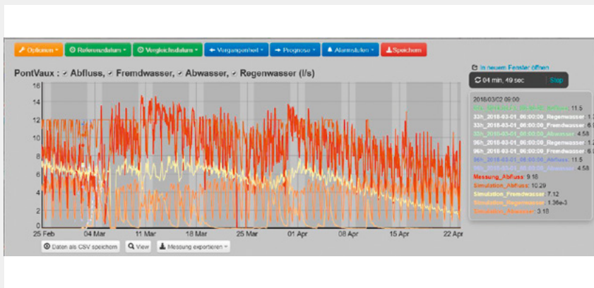
Fig. 4 Pumpstation PontVaux von März bis April 2018 (aus der Web-Plattform erm.swissrivers.ch ); Abfluss (Messung rot, Simulation braun), Fremdwasser Simulation (gelb), Abwasser Simulation (orange) und Regenwasser Simulation (hell orange), saisonale Unterschiede durch Anteil Fremdwasser
