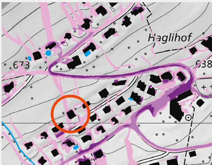
Fig. 1 Ausschnitt Gefährdungskarte Oberflächenabfluss und eingetretenes Schadenereignis. Hellrosa: < 10 cm, dunkelrosa: 10–25 cm, violett: > 25 cm Fliesstiefe; Kreis: Gebäude in der Foto rechts. (Karte: BAFU/Swisstopo; Foto: Schadenakte GVL)
