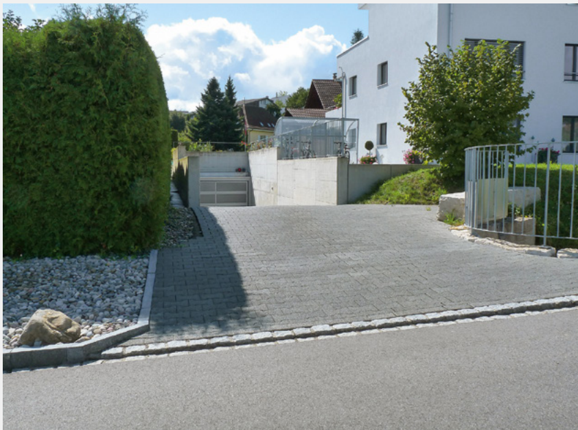
Fig. 8 Eine Kuppe vor der Einfahrt in die Tiefgarage verhindert deren Flutung. (Foto: VKG)
