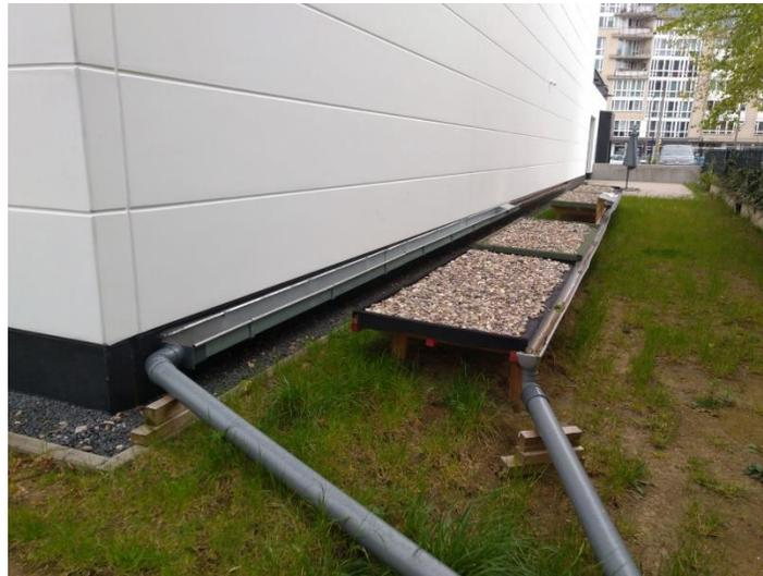
Praxisversuch, Entwässerung von ca. 150 m<sup>2</sup> Fassadenfläche und 10 m<sup>2</sup> EPDM-/ Bitumendachbahn
