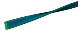
Tordierung durch Materialanisotropie im Zugversuch
