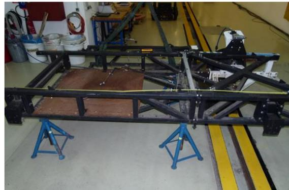
Bestehender Stoßwagenrahmen als Ausgangsbasis für Konstruktion
