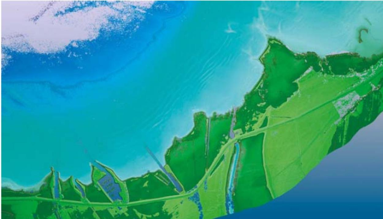
**Abb. 7** Topo-bathymetrische Daten der Flachwasserzone bei Rohrspitz westlich der Rheinmündung prozessiert und visualisiert in HydroVISH. Die komplexe Morphologie des Seebodens wird gut sichtbar und ist hier charakterisiert durch langgezogene, uferparallele Megarippel
