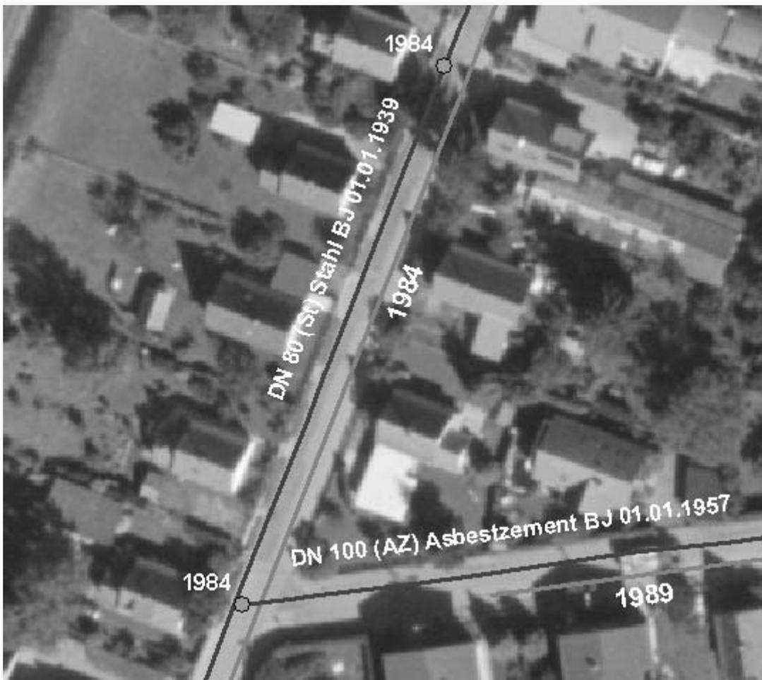
**Abbildung 3: Beispiel eines Schadens (Kreis) an einer Trinkwasserleitung mit Abwasserleitung**
