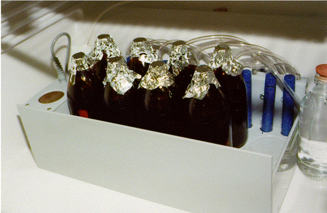
**Abb. 6.3** Die mit Aluminiumfolie leicht abgedeckten Inkubationsgefäße auf einem Magnetrühruntersatz der Fa. Aqualytic
