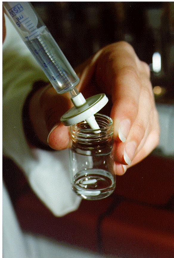
**Abb. 6.5** *Membranfiltration und Befüllen eines Probenfläschchens mit einer DOC-Probe*
