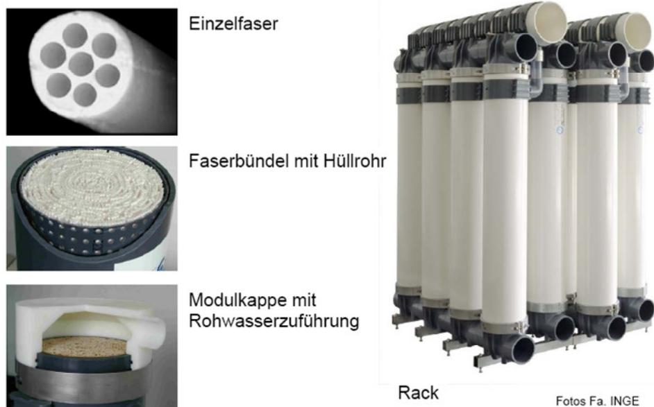
Abbildung 13: Modulaufbau (Beispiel Fa. Inge) (aus KRAUSE S., 2009)
