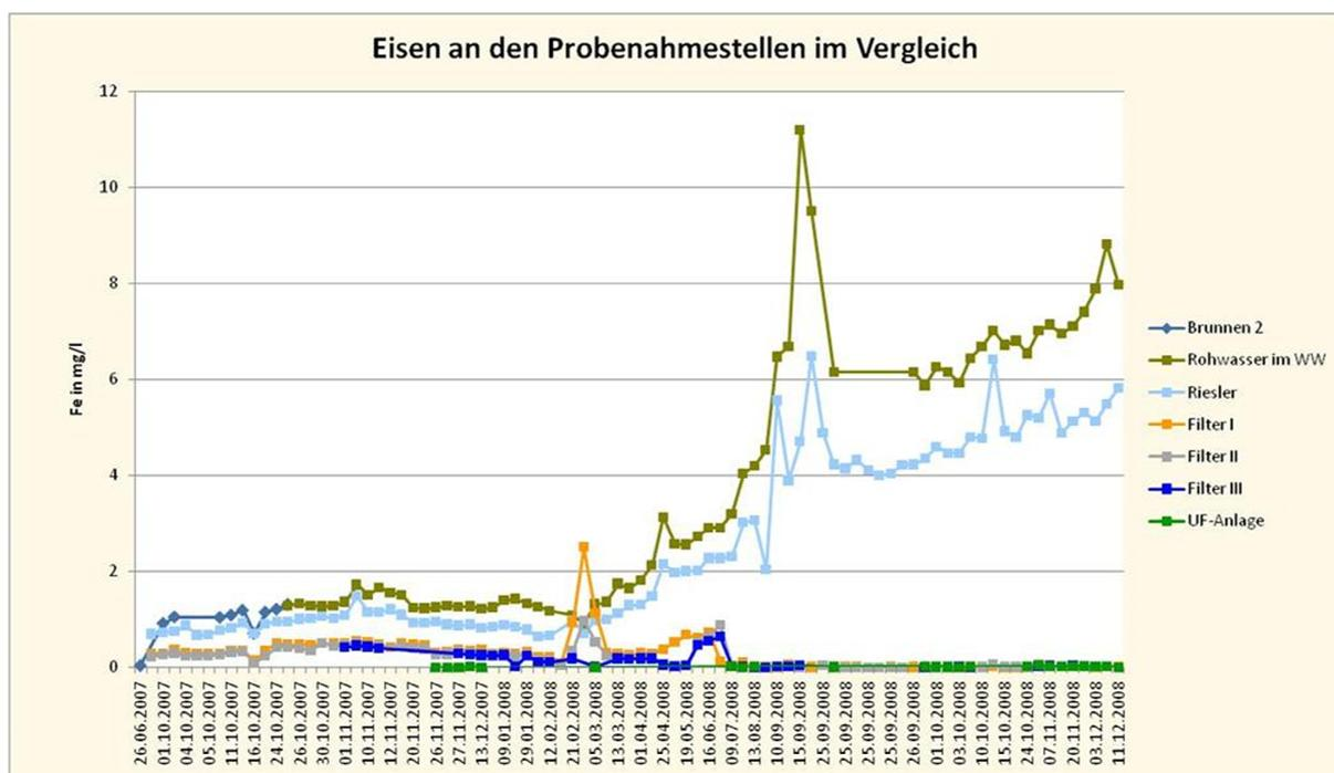
**Abbildung 26:** Entwicklung der Eisengehalte in den einzelnen Aufbereitungsstufen (aus KÖLBL J. et al., 2009b)
