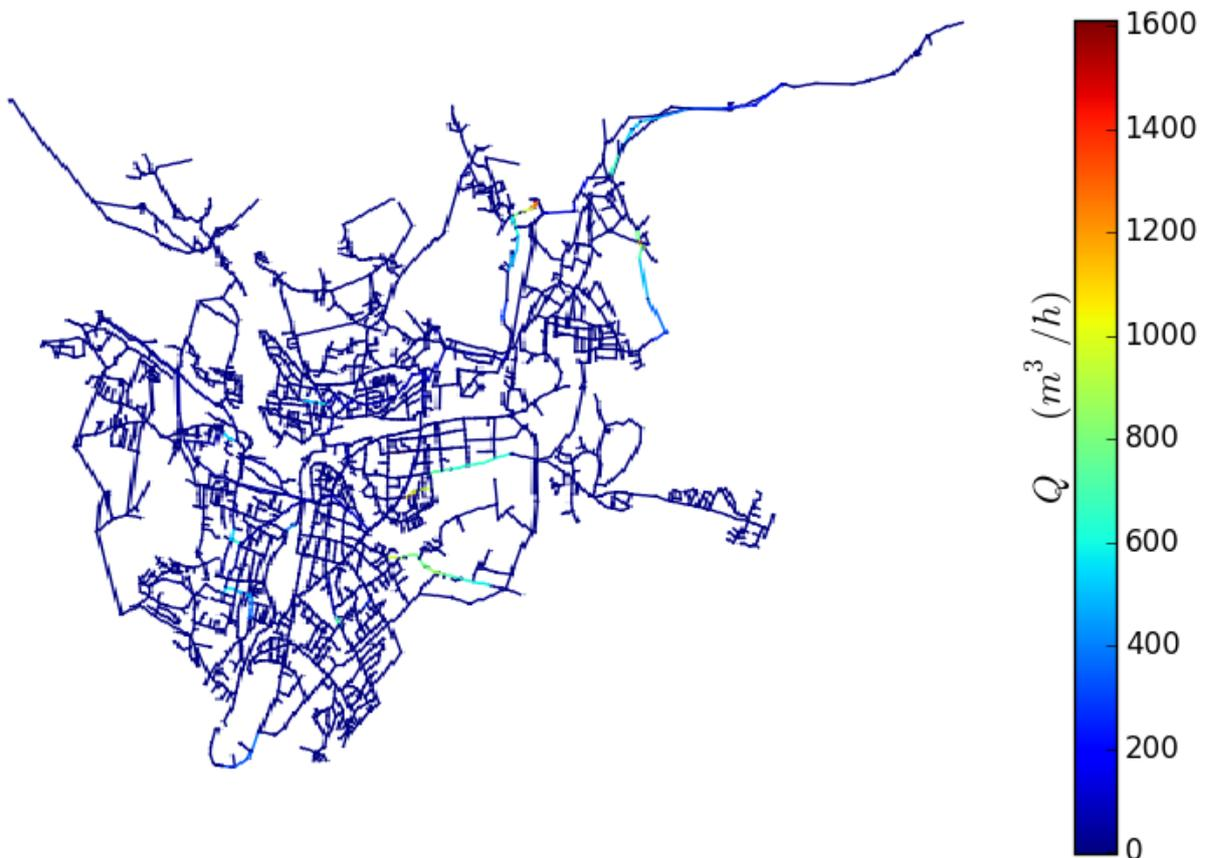
Abbildung 16: SLC-Ausflussmenge bei Längsriss  $l=200\text{cm}$
