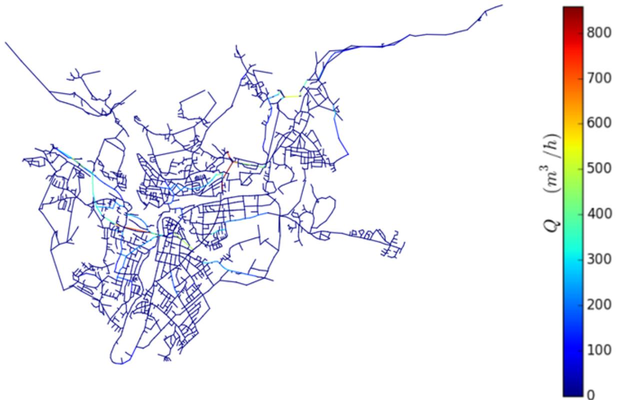
Abbildung 15: ILC-Ausflussmenge bei Längsriss  $l=40\text{cm}$
