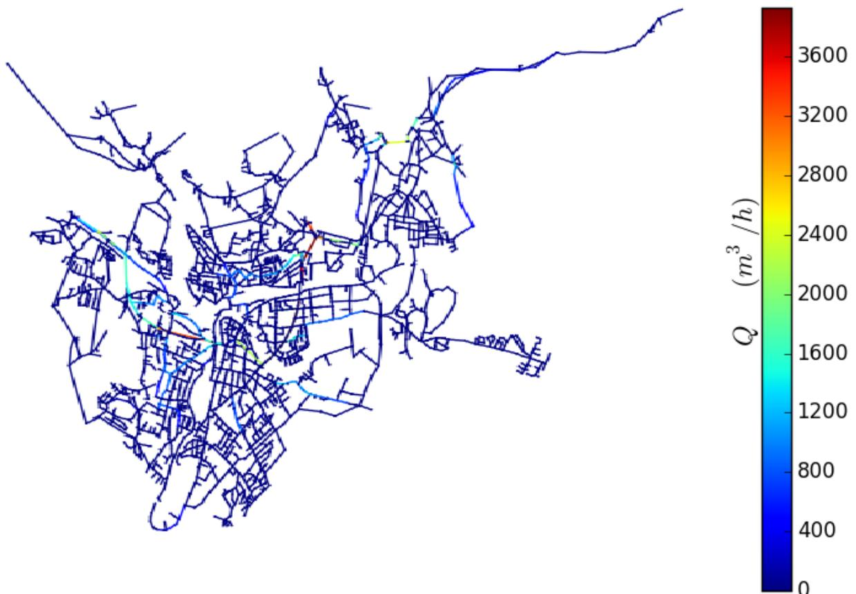
**Abbildung 17: ILC-Ausflussmenge bei Längsriss l=200cm**
