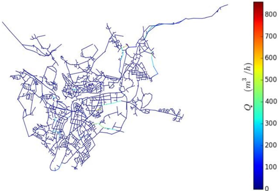
Abbildung 14: SLC-Ausflussmenge bei Längsriss  $l=40\text{cm}$
