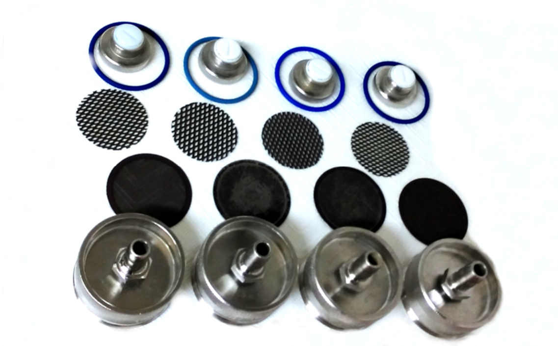
Abbildung 4-7: Vier Paare Unterbau-Schraubverschlüsse zur Aufnahme der Lochbleche, der Siebe, der Filter (nicht dargestellt) und der Dichtringe sowie die vier Zylinderverschlüsse zum Verschließen der Druckfiltrationsgeräte (von unten nach oben aufgelegt)
