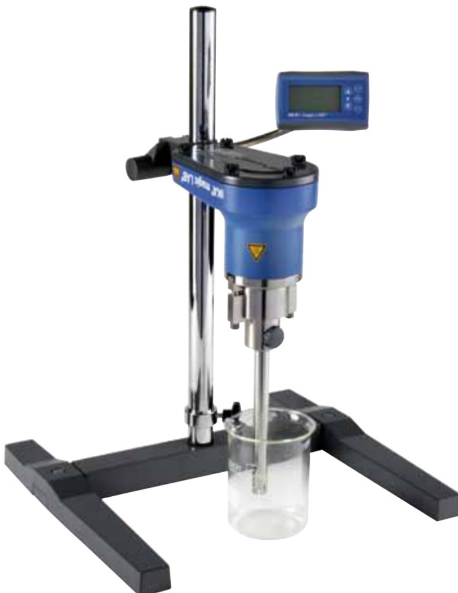
Abbildung 4-2: Verwendetes Homogenisierungsgerät IKA ULTRA TURRAX T 50 DIGITAL
