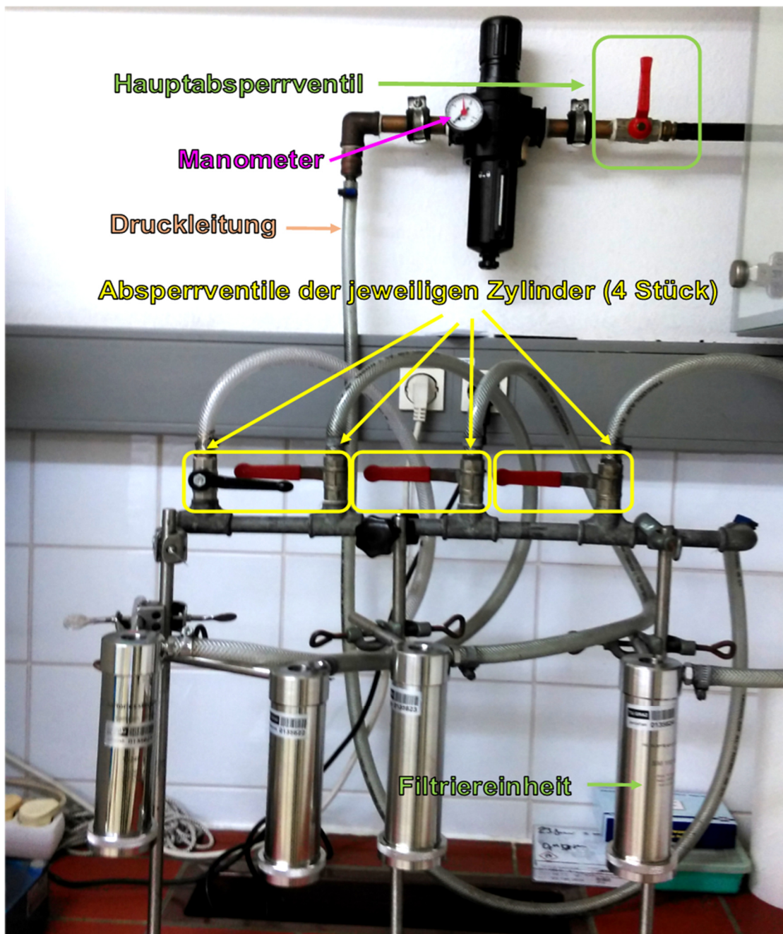
Abbildung 4-6: Die vier Druckfiltrationszylinder, das Hauptabsperrventil und die vier Sperrventile der jeweiligen Zylinder im Labor des Instituts.
