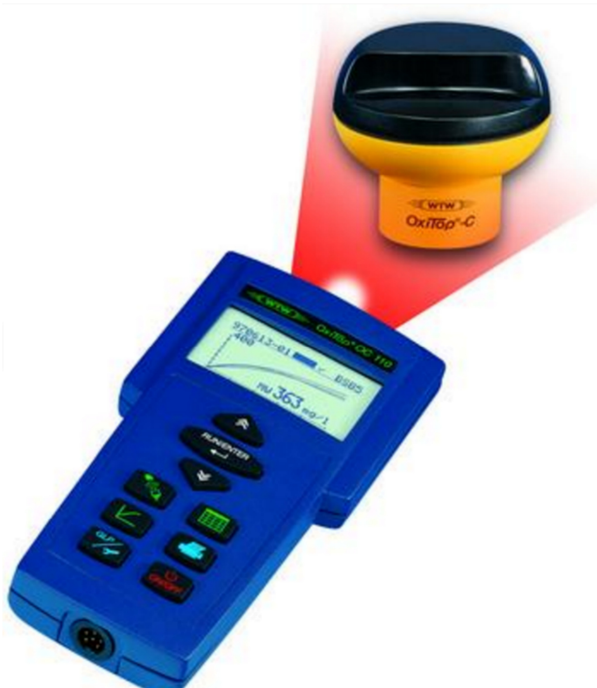
Abbildung 4-4: Ausrichtung des Controllers zum Messkopf während des Starts und Datentransfers
