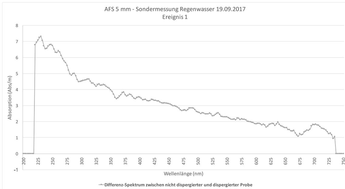
Abbildung 4-22: Differenzspektrum auf Basis der spectro::lyser Sonde (5 mm) der ersten Messung in der dispergierten Probe zum Zeitpunkt 0 und der Vergleichsmessung in der nicht dispergierten Probe
