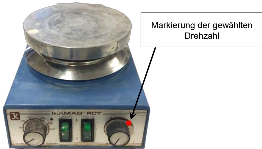
Abbildung 20: Magnetrührer mit Markierung für die Drehgeschwindigkeit
