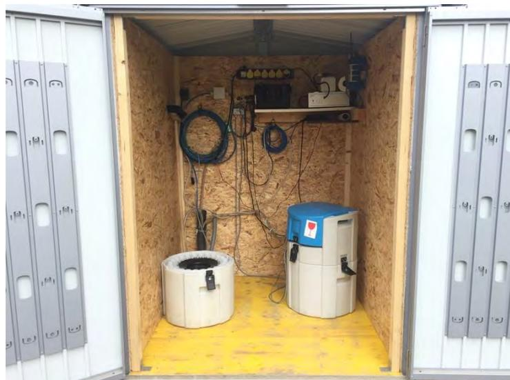
Abbildung 4: Messhütte mit dem installierten Probenahmegeräten an der MS-Niederschlagswasser
