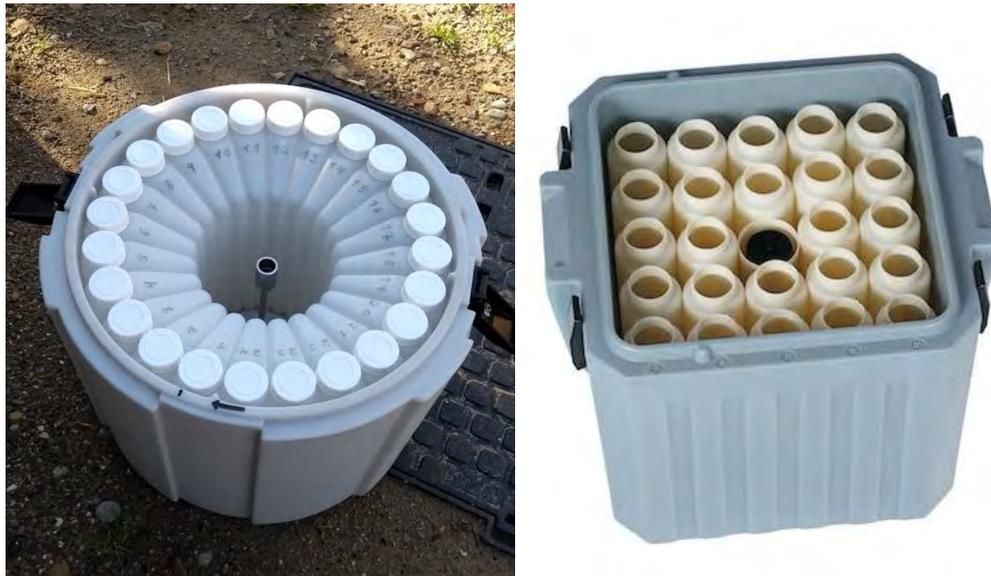
Abbildung 13: Probenahmeuntersatz des E+H-Probenahmegerät (links) und MAXX-Probenahmegerät (rechts)
