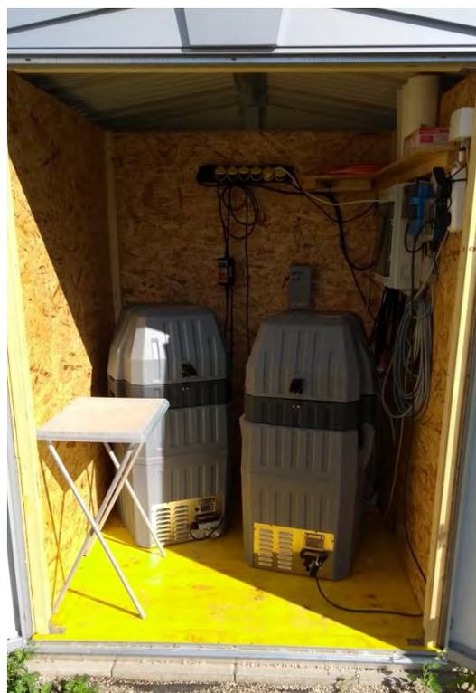
Abbildung 2-19: Messhütte mit den Probenahmegeräten an der MS-Mischwasser
