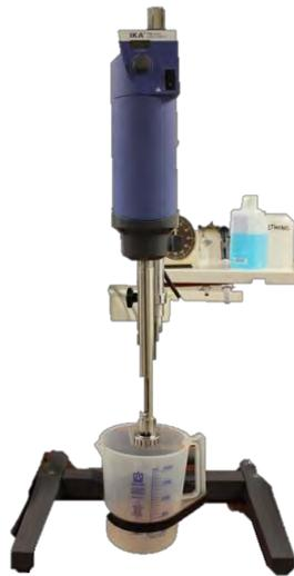
Abbildung 24: Verwendetes Dispergiergerät IKA ULTRA TURRAX T 50 DIGITAL
