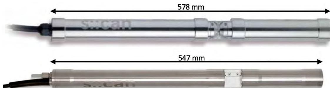
Abbildung 3-2: Spectro::lyser Sonde der ersten (oben) und zweiten (unten) Generation (Firma s::can Messtechnik GmbH: <http://wwws-can.at>, Zugriff am 19.09.2017)
