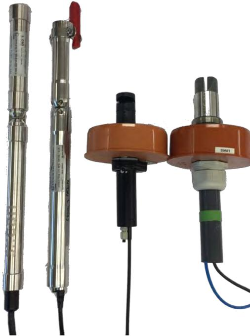
Abbildung 5: spectro::lyser 5 mm, spectro::lyser 2 mm, i::scan 5 mm, soli::lyser (von links nach rechts)
