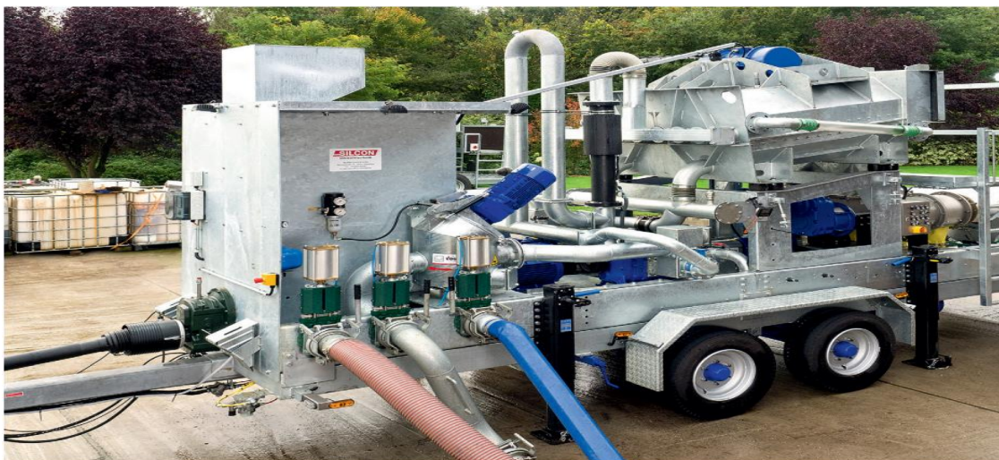
Abbildung 4-13: Mobiles Vibrationssieb V 2 S mit integrierter Pressschnecke (SILCON GmbH & Co.KG, 2017)
