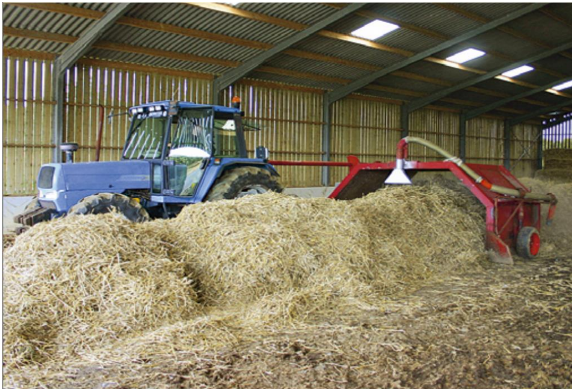
Abbildung 5-6: Spezielles Einmischgerät zur Einbringung von Gülle in eine Strohmiere (Kenevez & Mongredien, 2009)
