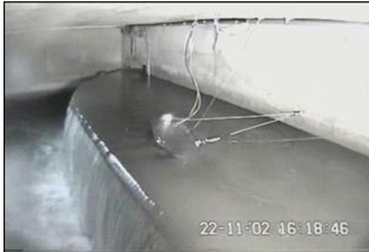
Abbildung 2-5: Ponton in der Mischwasserüberlaufkammer (Gruber *et al.*, 2004)
