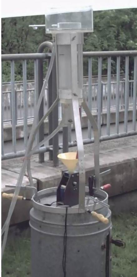
Der Wasserbehälter wird mit einer beliebigen Wassermenge gefüllt oder während der gesamten Versuchsdauer ständig mit Wasser befüllt. Vor dem Öffnen des Durchflussreglers ist sicherzustellen, dass der an die Wippe angeschlossene Zähler auf Null gestellt ist.
