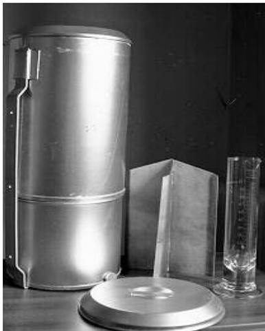
Im einfachsten Fall handelt es sich bei dem Sammelgefäß (Abbildung 2-8) um einen Metallzylinder, dessen obere Öffnung  $200 \text{ cm}^2$  groß ist. In dem Metallzylinder befinden sich ein Trichter und darunter ein Sammelgefäß. Mit einem geeichten Messzylinder wird die Niederschlagsmenge mit einer Genauigkeit von  $1/10 \text{ mm}$  bestimmt. Eine Niederschlagshöhe von  $1 \text{ mm}$  entspricht einer Niederschlagsmenge von  $1000 \text{ cm}^3/\text{m}^2$  oder  $1 \text{ l/m}^2$ .
