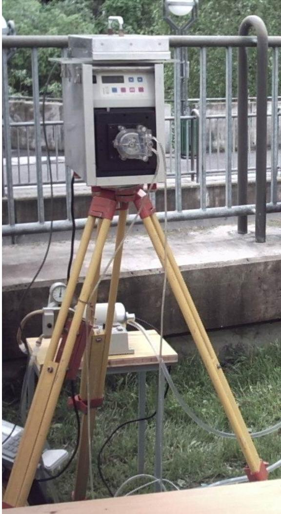
Die Peristaltikpumpe der Firma ISMATEC ist eine vielseitig einsetzbare Pumpe, die je nach Wahl des Pumpensystems zum Dosieren als auch zum Fördern bestens geeignet ist. Sie dient der Einstellung und kontinuierlichen Förderung eines zeitlich konstanten Durchflusses (Sollwert  $i_0$  der Niederschlagsintensität).
