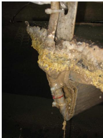
**Abbildung 2.10:** Schlauch für Probenahme am Heck des Pontons
