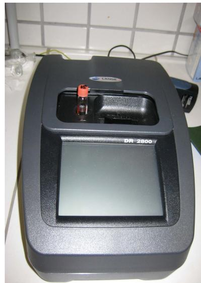
**Abbildung 3.8:** Küvetten mit unterschiedlicher CSB-Konzentration und Spektralphotometer Hach Lange
