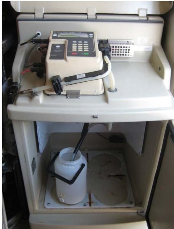
Abbildung 2: Gekühltes Probeentnahmegesetz (Messstation Graz)
