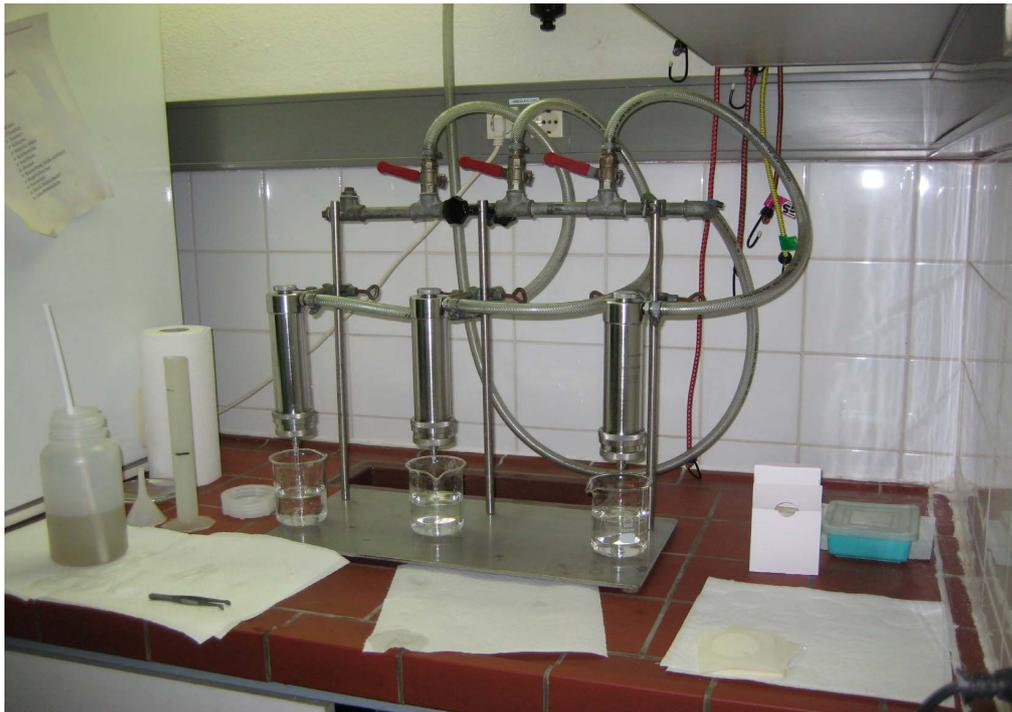
**Abbildung 3.9:** Versuchsanordnung AFS
