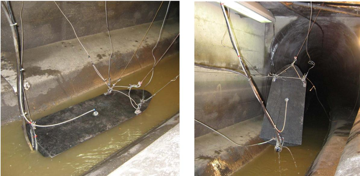
**Abbildung 2.7:** Ponton mit integriertem UV/VIS-Spektrometer
