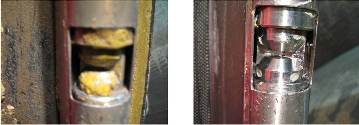
**Abbildung 2.9:** Messfenster vor bzw. nach erfolgter Reinigung
