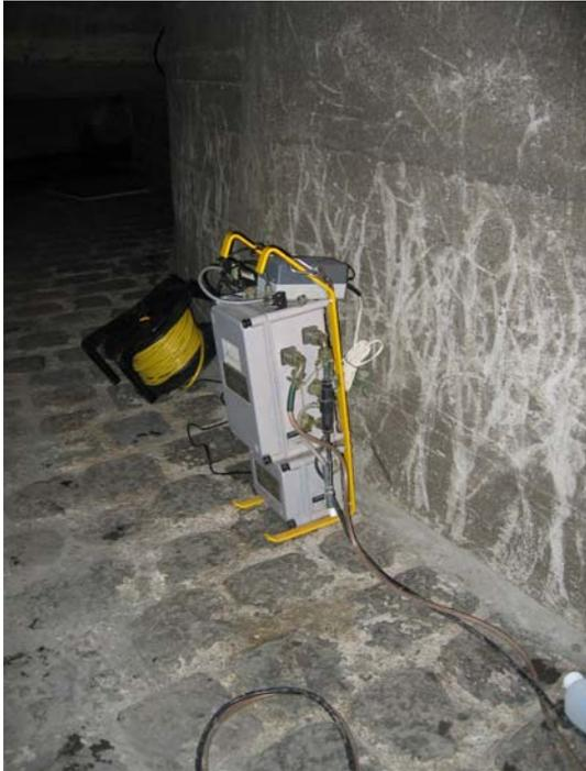
Abbildung 4-4: Datenlogger und Energieversorgung des Q- Loggers
