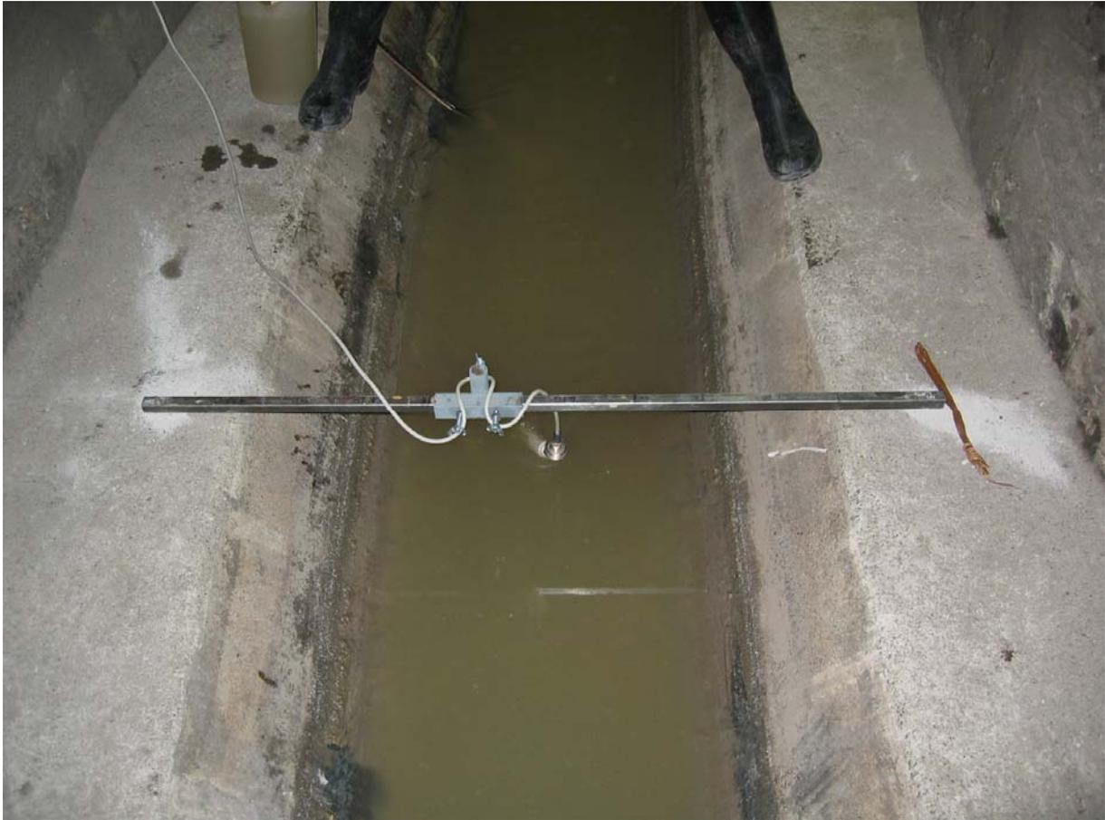
Abbildung 4-5: Montage der Leitfähigkeitssonde in der Trockenwetterrinne des Mischwasserkanals
