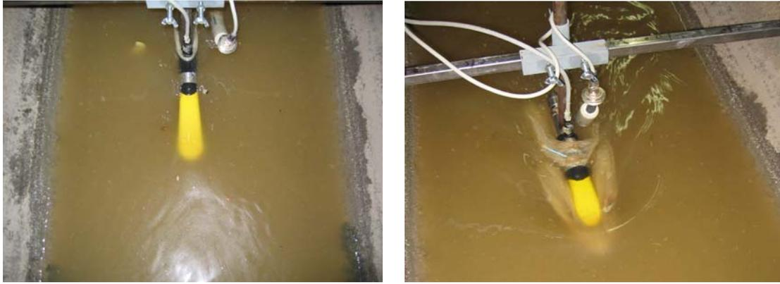
Abbildung 4-2: Montage und Situierung der MID-Sonde
