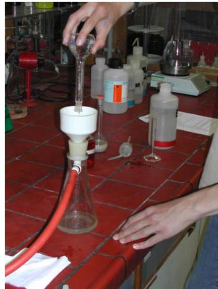
Abb. 31: Probe wird abgesaugt
