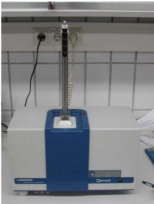
**Abb. 37: Fotosedimentometer LUMOSED**
