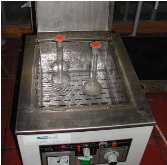
Abb. 30: Probe wird durchvibriert
