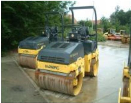
Abbildung 55: Vibrationswalze
