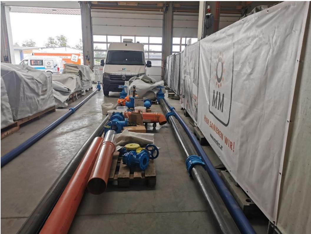
Abbildung 4-1: Versuchsaufbau mit Leitungsanfang im Hintergrund nach den ersten Eigenversuchen in der Firmenhalle der Fa. MM Kanal-Rohr-Sanierung GmbH.
