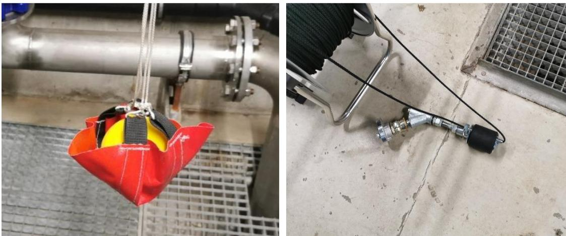
Abbildung 3-6: Einblaskörper (linkes Foto) und Rohrverschlussstopfen (rechtes Foto).
