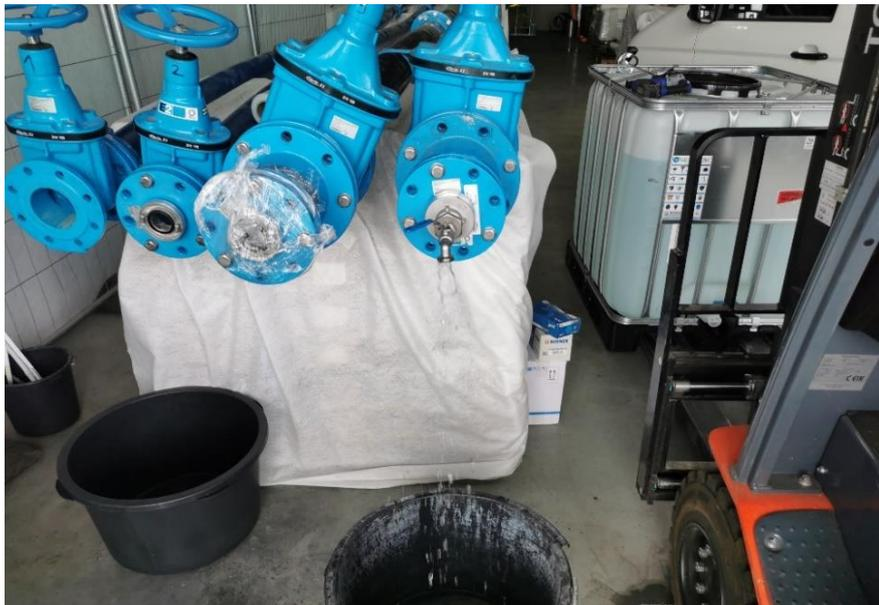
Abbildung 6-8: Probenahme am Ende der L4 während der 14-tägigen Langzeitanalyse
