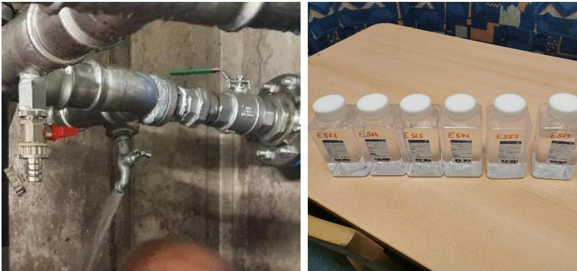
Abbildung 6-24: Probenahme am Leitungspunkt E (linkes Foto: Gruber) und die entnommenen Wasserproben während des Versuchs 7 (rechtes Foto).
