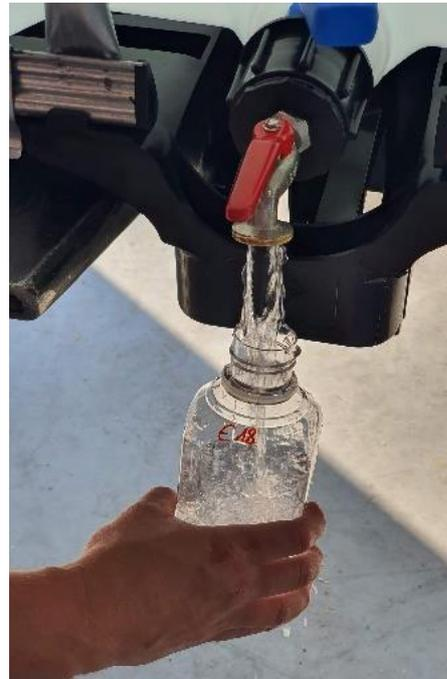
Abbildung 6-6: Entleerung der Leitung 1 (linkes Foto) und eine Mischprobe aus Behälter 2 (rechtes Foto) (Fotos: Gruber).
