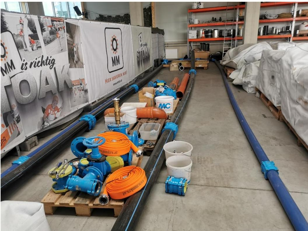
Abbildung 4-2: Versuchsaufbau mit Leitungsenden im Hintergrund nach den ersten Eigenversuchen in der Firmenhalle der Fa. MM Kanal-Rohr-Sanierung GmbH.
