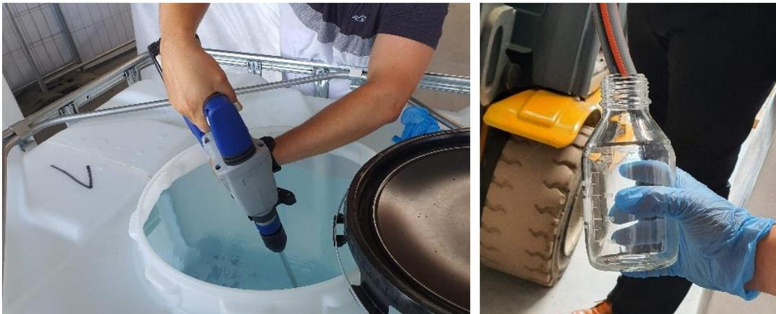
Abbildung 6-4: Durchmischung des Behälters 1 (linkes Foto) und Probenahme des Mischwassers (rechtes Foto) (Fotos: Gruber).
