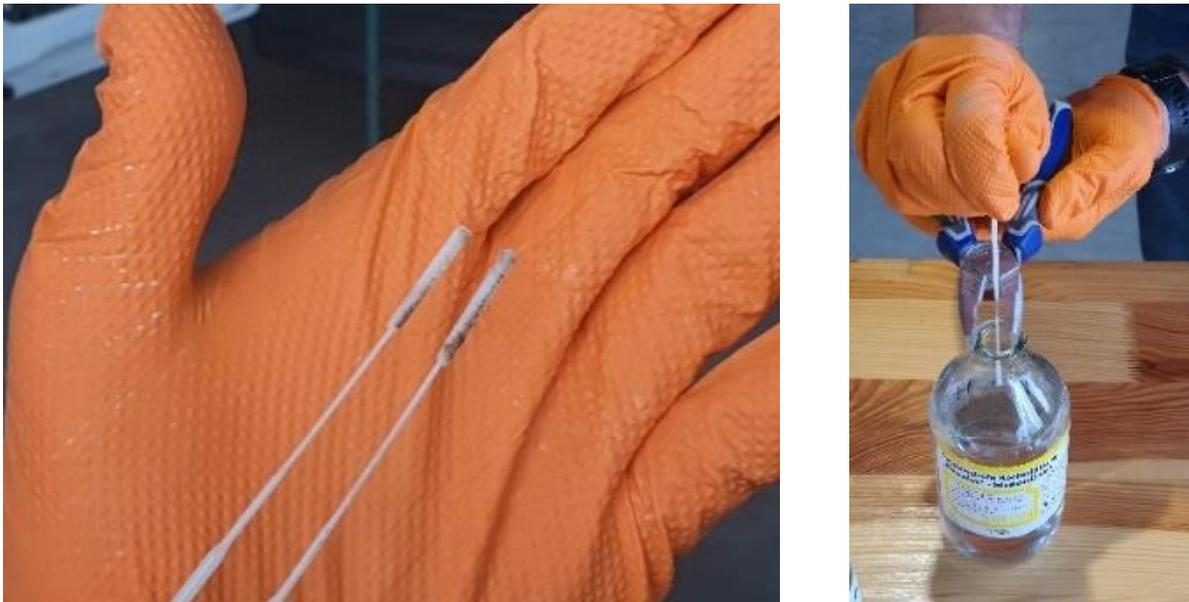
Abbildung 6-29: Mit Biofilm kontaminierte Teststäbchen nach der L.E.S.S.-Behandlung (linkes Foto) und die Teststäbchen vor dem Abschneiden (rechtes Foto) und Aufbewahrung in den sterilen und mit Kochsalzlösung befüllten Probeflaschen (Fotos: Gruber).
