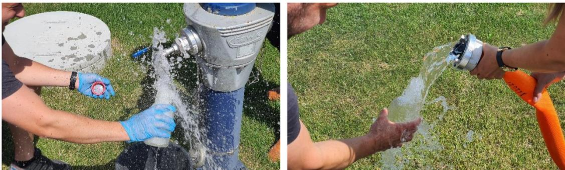
Abbildung 6-2: Probenahme direkt am Hydranten (linkes Foto) und am Ende des Druckschlauches (rechtes Foto) (Fotos: Gruber).
