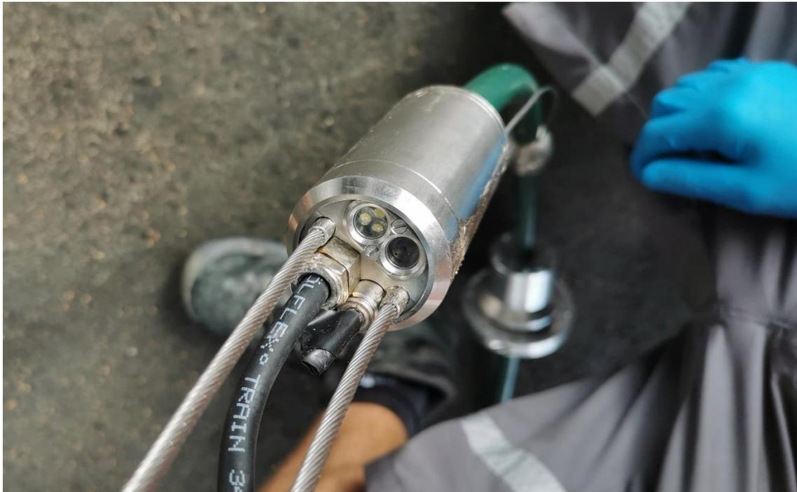
Abbildung 3-8: Installierte Kamera- und Lichteinheit am L.E.S.S. zur visuellen Kontrolle des Desinfektionsvorganges in den Rohrleitungen.
