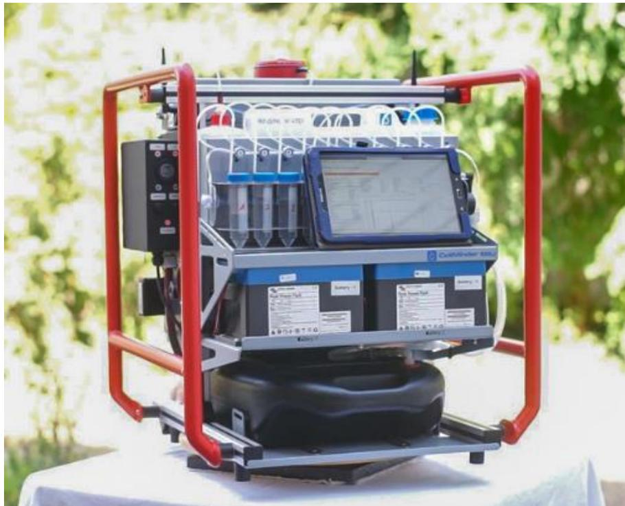
Abbildung 2-6: ColiMinder CMI-02-ERU-Mobile (Emergency Response Unit) (VWMS GmbH, 2023).
