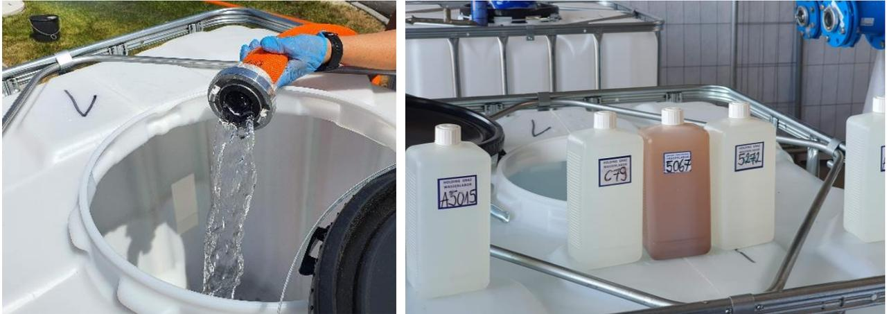
Abbildung 6-3: Befüllung des Behälters 1 mit Trinkwasser (linkes Foto) und Beimengung des „Keimcocktails“ (rechtes Foto) (Fotos: Gruber).
