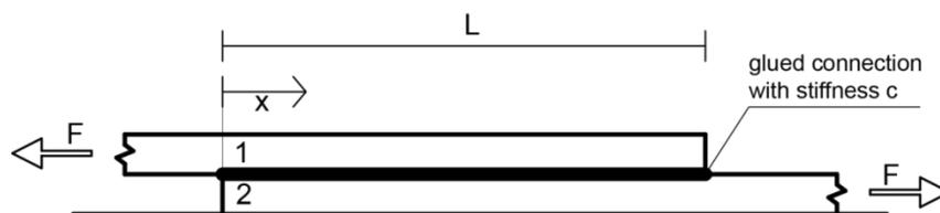
Abb. 10: Verbindung auf Abscheren mit elastischer Ebene
