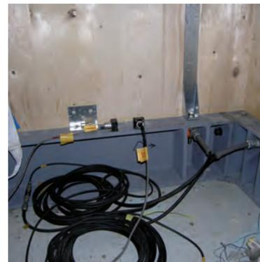
*Fig. 3.12: Accelerometers*
