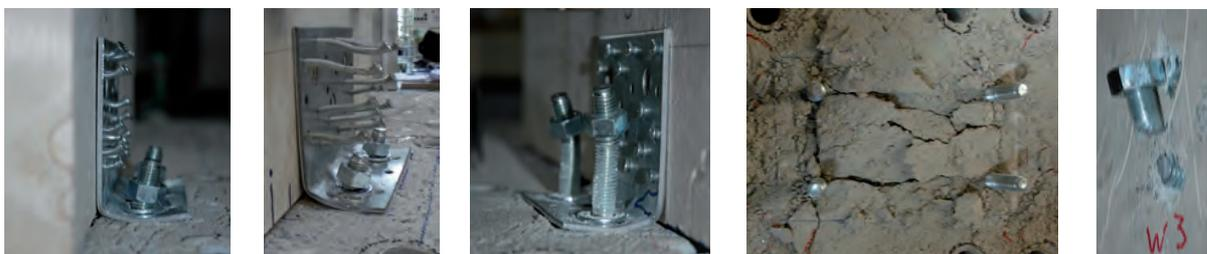
*Abb. 3.10: Verankerung im Beton; von links nach rechts - Versagen von Nägeln und Betonankern | Versagen der Nägel | Herausziehen der Verankerung | Betonausbruch | Stahlversagen der Anker*
