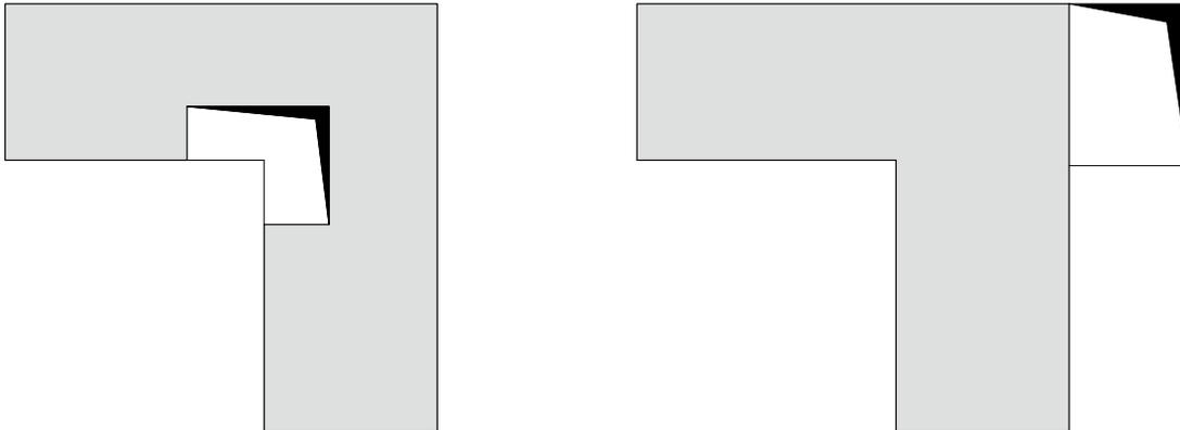
**Abb. 2.8:** Beispiel einer ungünstigen Deckenöffnung (linkes Bild) und Lösungsvorschlag (rechtes Bild) (nach [5])
