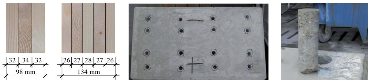
Abb. 3.6: Materialien von links nach rechts: BSP-3s / BSP-5s / Beton-Zugelement / Beton-Bohrkernentnahme
