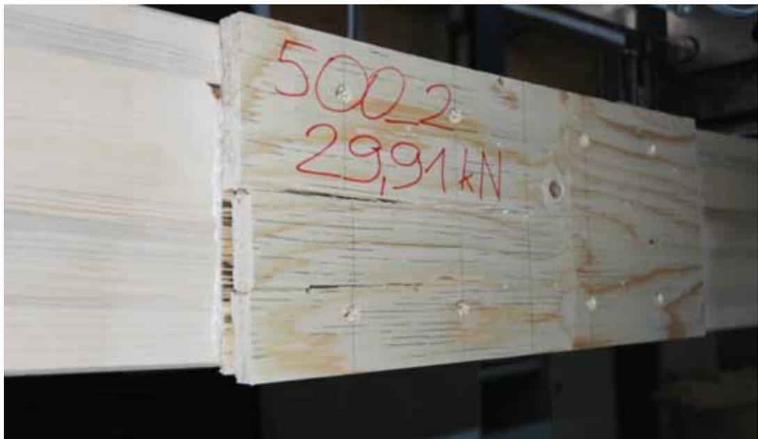
Abb. 4-2: Versuchsreihe V1; Schubversagen im Kerto-S
