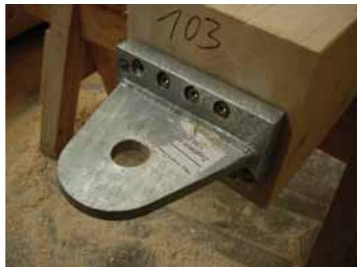
Abb. 2-17: Zugversuch Strebe
