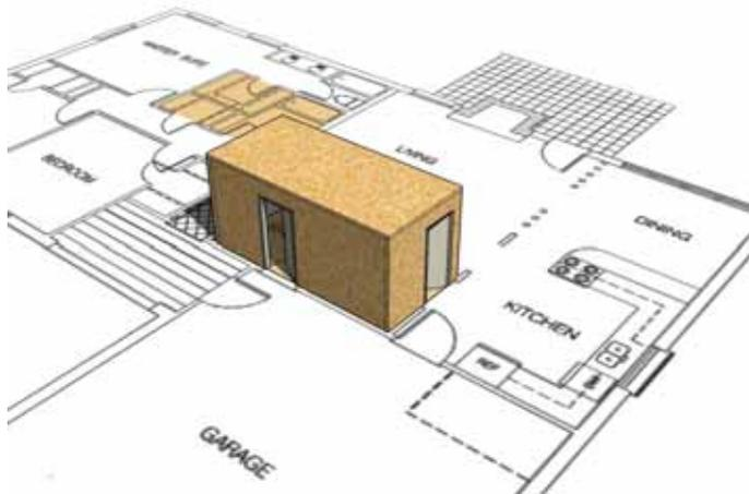
Abb. 10: „In residence tornado shelter“ – eingepasst in den Grundriss eines Einfamilienwohnhauses
