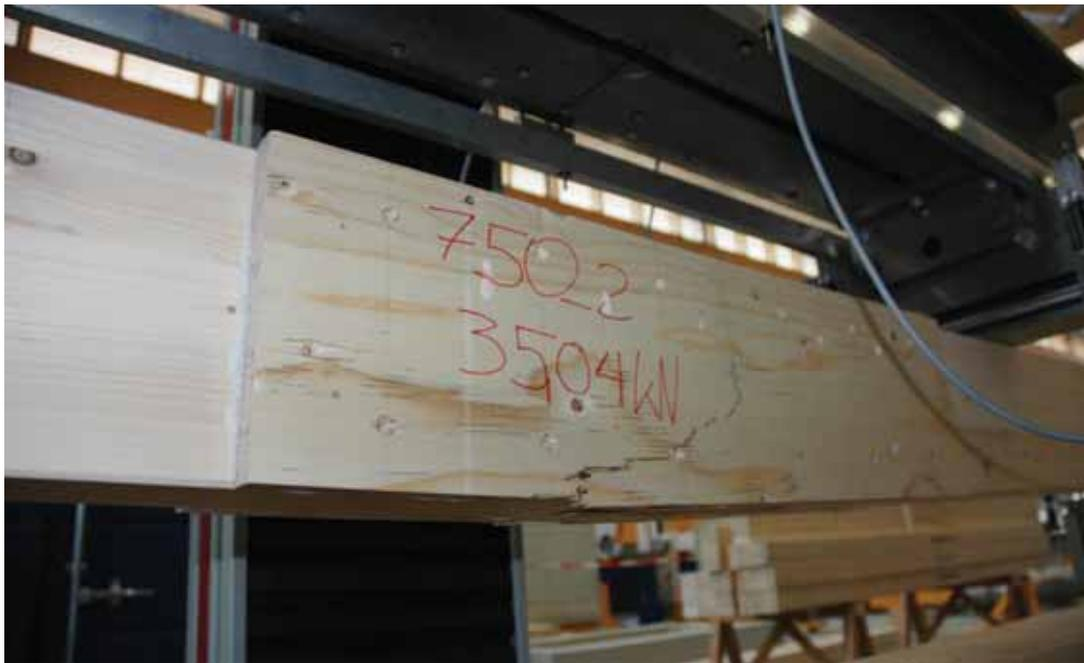
Abb. 4-3: Versuchsreihe V2; Biegebruch im Kerto-S
