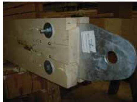
Abb. 2-4: Mit Vollgewindeschrauben verstärkt
