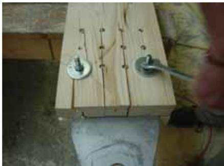
Abb. 2-3: Unverstärkte Verbindung
