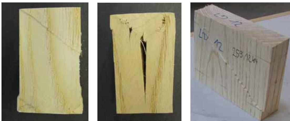
Abb. 2-11: Längsdruckprüfkörper – Götterbaum (*Ailanthus altissima* (Mill.) Swingle): Längsdruckprüfungen an ‚clear wood‘ (links + mitte); Längsdruckprüfung an ‚construction timber‘ (rechts): Ausbildung von Schubkeilen und Scherbändern in 45°-Ebenen (vgl. auch Mattheck (2003))
