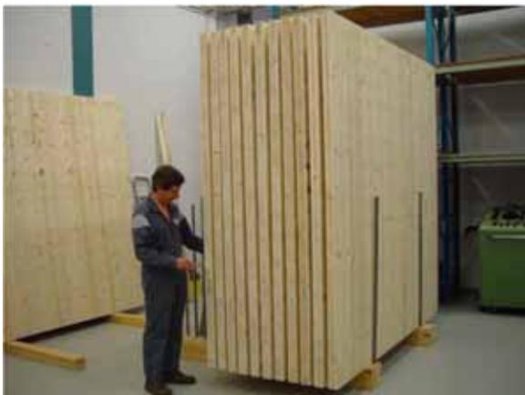
Abb. 2.1: BSP Platten gelagert in einem Klimaraum der Empa
