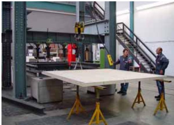
Abb. 2.2: Einschieben einer BSP Platte in die Versuchseinrichtung
