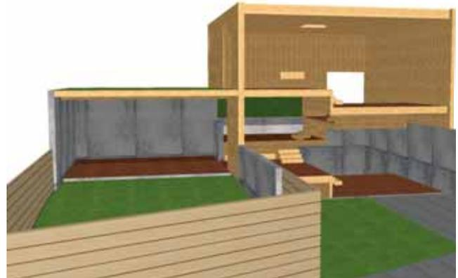
Der Raumkubus des Kernhauses mit einer Seitenlänge von ca. 8.00 m wird von sechs Ebenen mit ca. 3.00/4.20 m, die sich in Höhengsprüngen von jeweils 0.80 m um ein ‚Auge‘ von 1.20/1.20 m nach oben drehen, gegliedert; so entsteht ein zusammenhängender, differenzierter Raum der in vielfältiger Weise besiedelt werden kann. Im Zentrum kann ein Ofen, eine Vitrine oder eine große Pflanze stehen.
