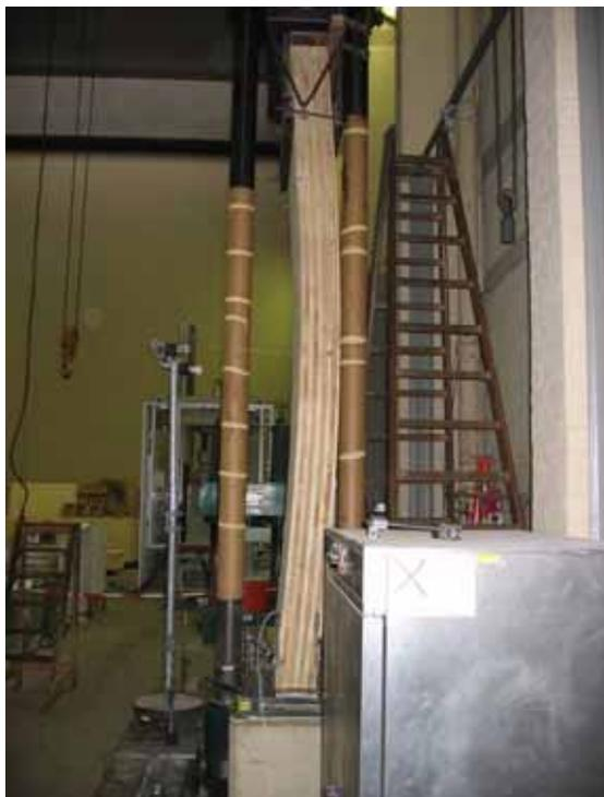
Abb. 3.9: Knickversuch an genageltem Brettsperrholz (1)
