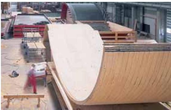
Abb. 6.4: Schalenskonstruktion, Aussegnungshalle Gräfelfing, [Merk/Finnforest]
