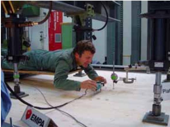
Abb. 2.9: Dehnungsmessungen mit Deformeter an Plattenoberseite
