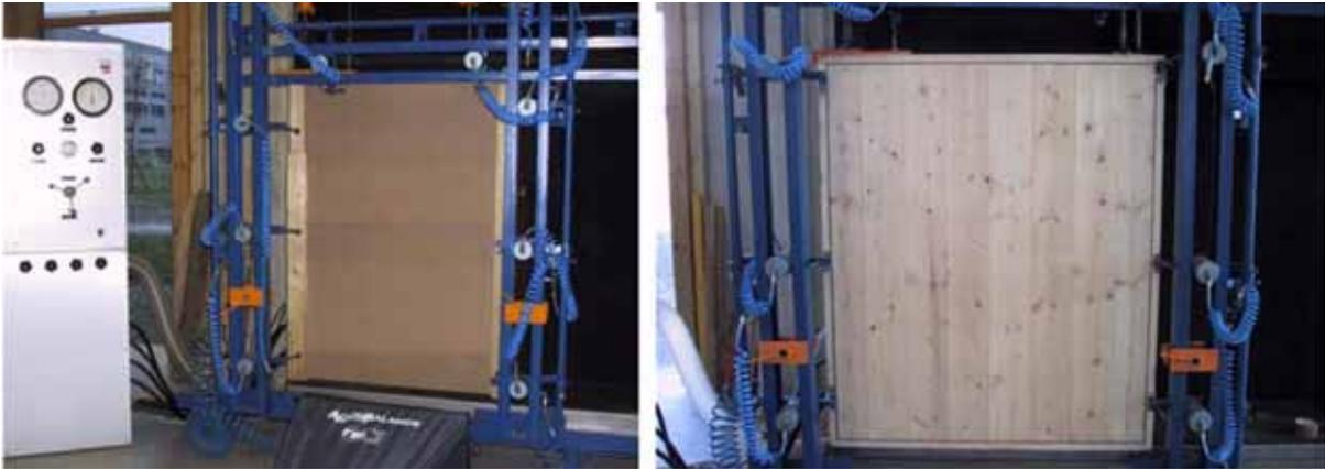
Abb. 2.3: Untersuchung der Luftdichtheit von Wandelementen / Labor für Bauphysik [1]. TU Graz.
