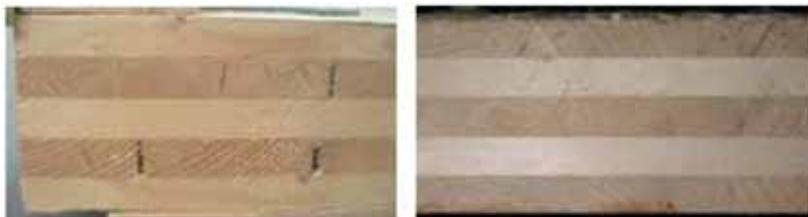
Abb. 2.2: Unterschiedliche Plattentypen in Bezug auf die Luftdichtheit
