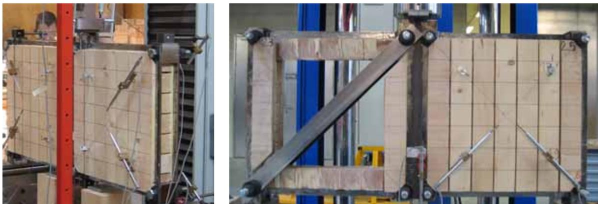
Abb. 4.5: Versuchskonfiguration im eingebauten Zustand (links: Versuchskonfiguration I bzw. II; rechts: Versuchskonfiguration III)
