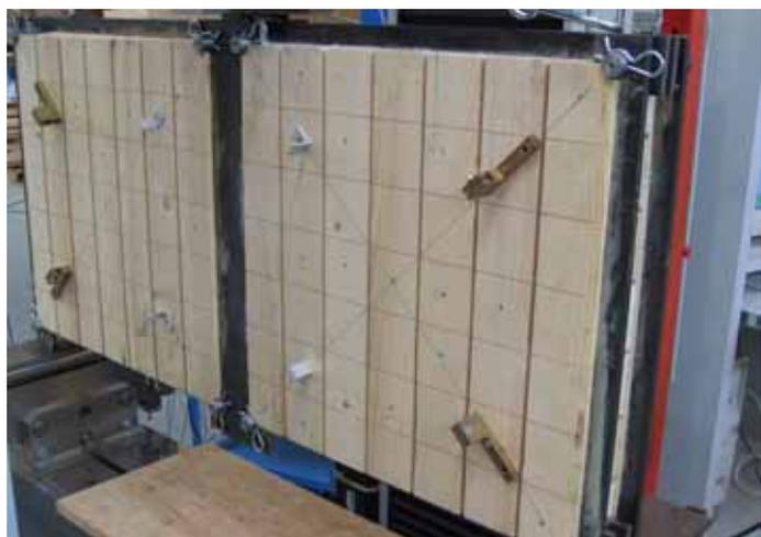
Abb. 2.6: Schubversuch an einem BSP-Element
