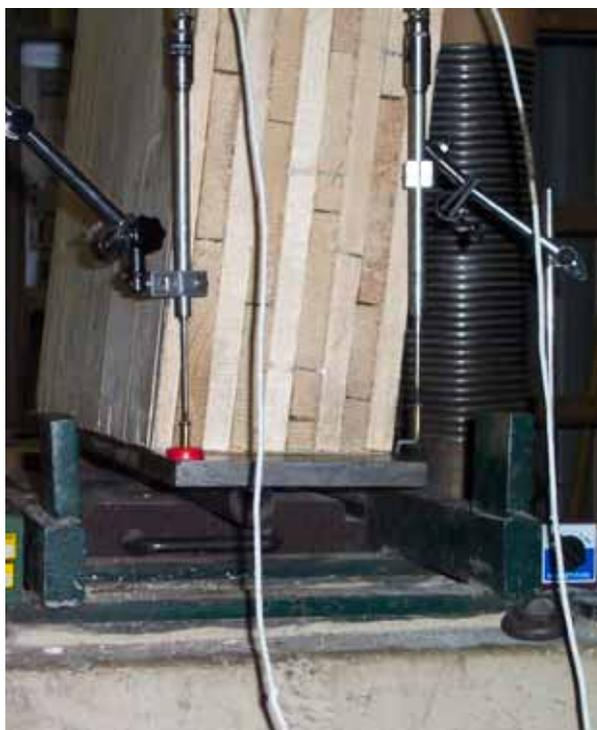
Abb. 3.10: Knickversuch an genageltem Brettsperrholz (2)
