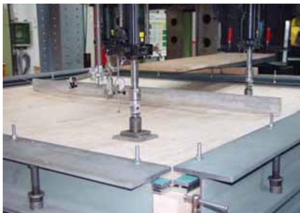
Abb. 2.8: Belastete BSP Platte mit gegenüber einer Referenzplatte sichtbarer Durchbiegung
