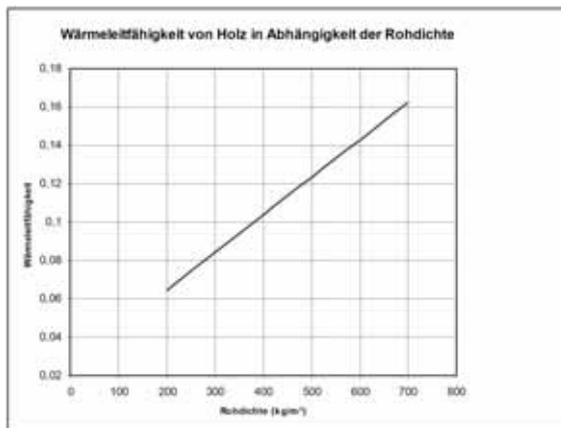
Abb. 2.4: Wärmeleitfähigkeit von Massivholz in Abhängigkeit der Rohdichte
