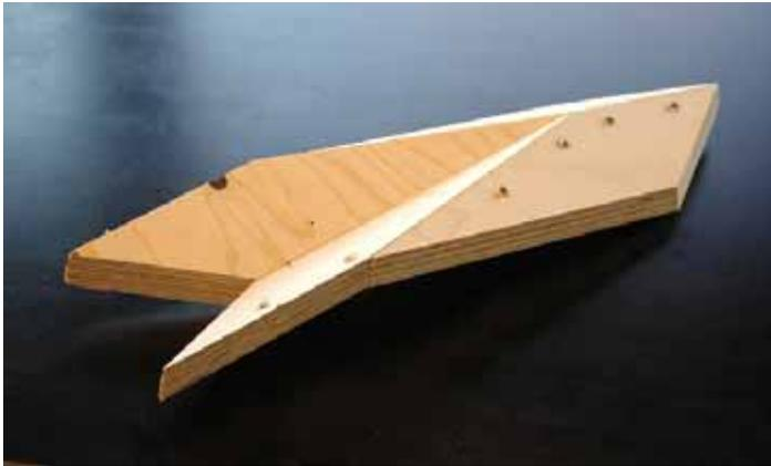
Abb. 5.3: Zusammensetzen zweier V-Elemente
