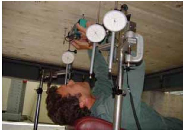
Abb. 2.10: Dehnungsmessungen mit Deformeter an Plattenunterseite, Messuhren für Durchbiegungsmessungen
