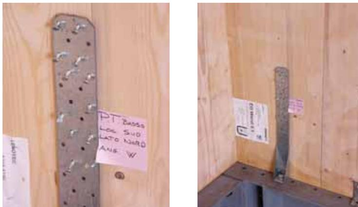
Abb. 5.2: Zugankerversagen nach Nocera Umbra 1,20g
