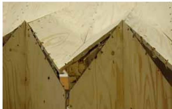
Abb. 5.7: Prototyp: Aufreißen der Verbindung
