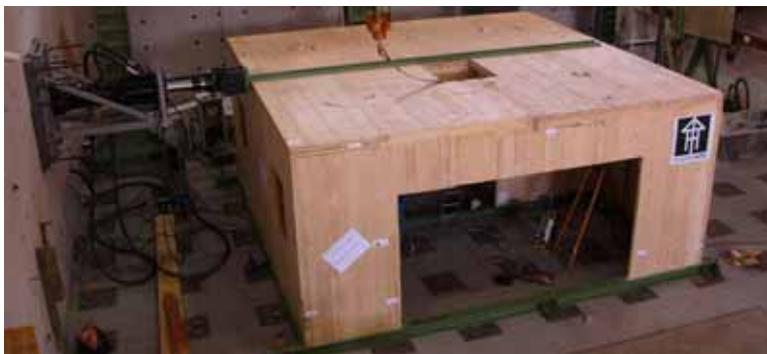
Abb. 4.1: Testaufbau der pseudodynamischen Versuche
