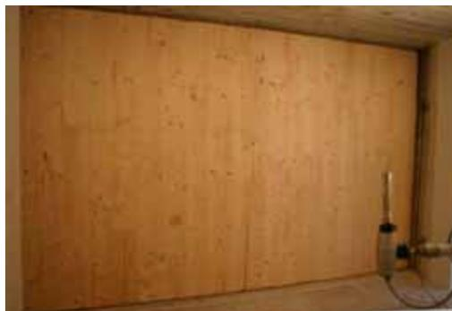
Abb. 3.2: Messung der Schalldämmung im Wandprüfstand des Labors für Bauphysik/TU Graz
