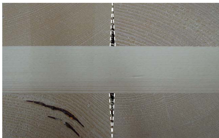
Abb. 2.3: Fugenschluss (4 mm Fuge) der Decklagen von Brettspertholz (3 x 40 mm) bei einer Holzfeuchteänderung von 6 %
