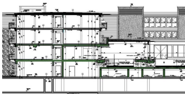
Abb. 2.22: Schnitt Schwimmbad- und Wellnessbereich. Holzbalkendecke ruht auf auskragender Balkonkragplatte.
