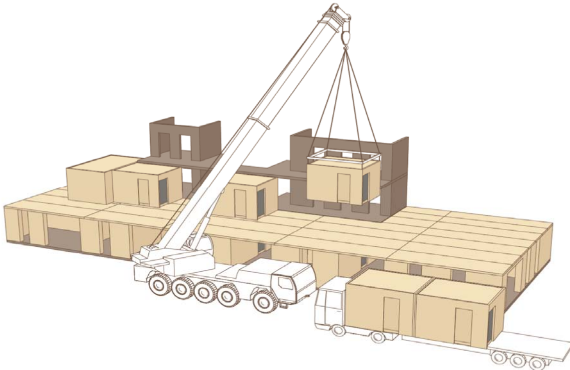
Abb. 3.4: Montagephase: Kombination Elementvorfertigung – Raumzellen
