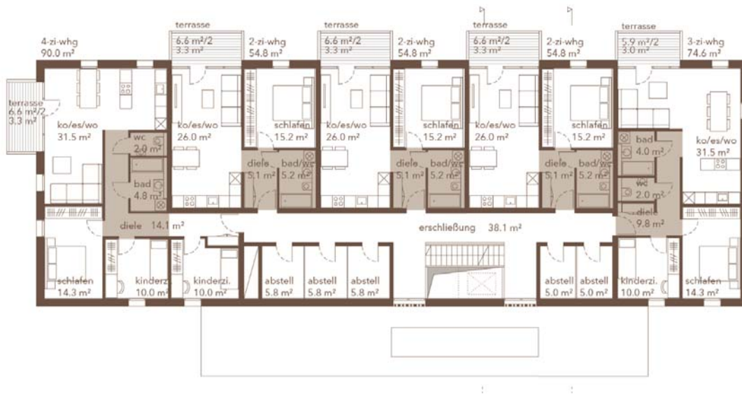
Abb. 3.3: Die Grundrisse des Passivhauses sind so entwickelt, dass sowohl die Nasszelle als auch die Erschließungszone als Raumzelle vorgefertigt werden können.
