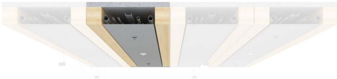
Abb. 3.11: HBV-Decke mit integrierter Leitungsführung und Untersicht aus perforiertem Blech für Heizung, Kühlung und Akustik
