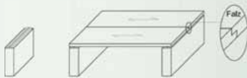
Versuchskonfiguration Einfeldplatte 2-seitig gelenkig gelagert
