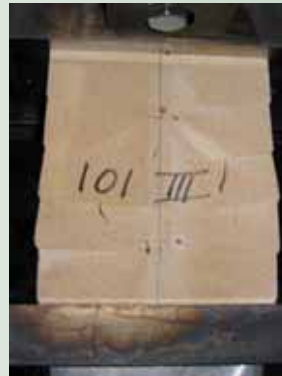
deutlich erkennbarer Querkontraktionseffekt und daraus resultierende Quersugrisse
