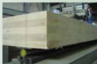
5-schichtiges BSP am Versuchsstand
