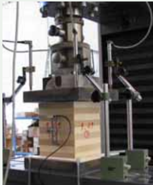
Versuchskörper mit Variation von Schichtdicke, Schichtanzahl, Lage des Brettes im Stamm, Aufbaufaktor und Beanspruchungssituation
