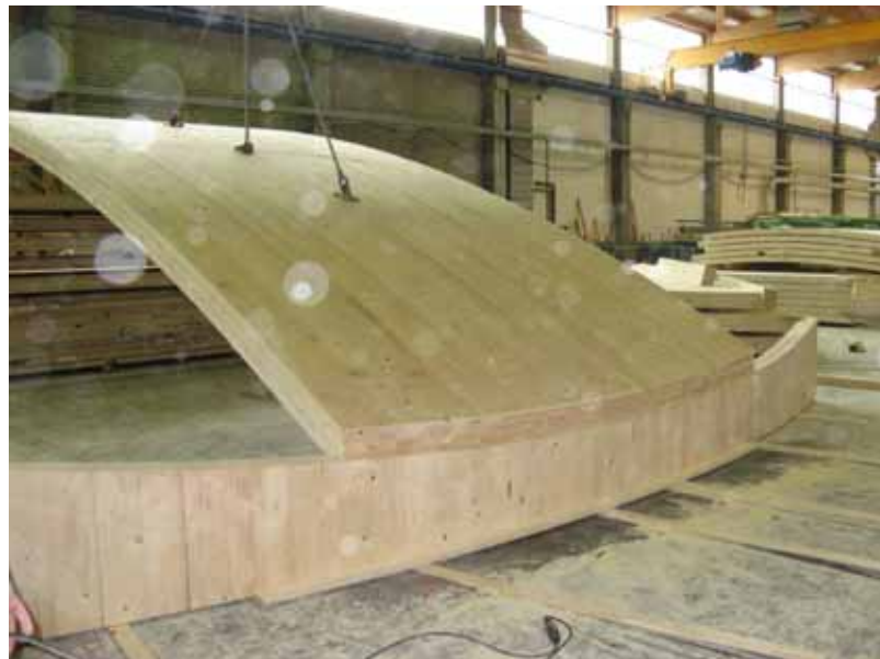
Traufanschluss zwischen runder Wand und Bogendach
