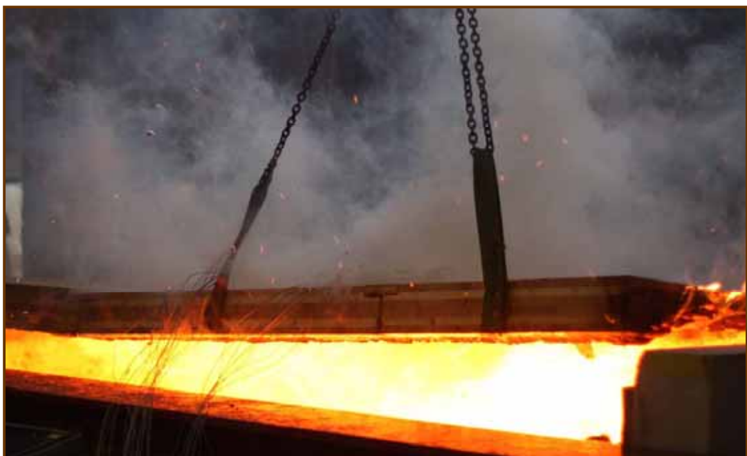
BBS Brandversuch | Decke REI 90
