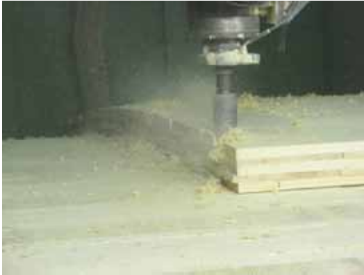
Abbund der runden Bauteile mittels CNC- Robotertechnik
