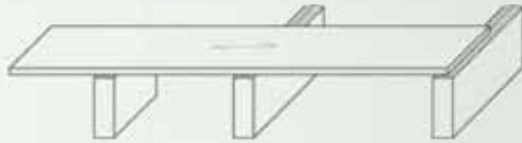
Versuchskonfiguration Zweifeldplatte mit Kragarm
