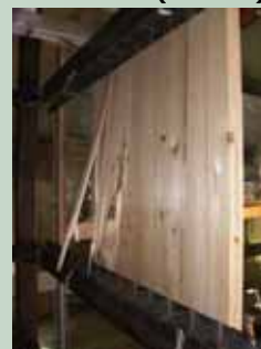
Versagen einer 3-schichtigen BSP-Platte (75 mm)
