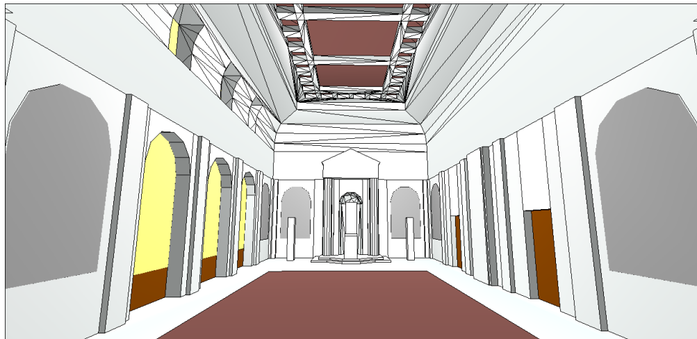
Abbildung 3.3: Das Simulationsmodell in „CATT-Acoustic“: Innenansicht
