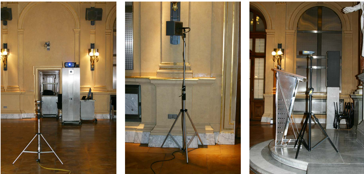
Abbildung 2.7: Messaufbau: Messung des Störgeräuschpegels (links), Messung der Laufzeitverzögerung (Mitte) und Bestimmung der exakten Messpositionen / Geometrie (rechts)
