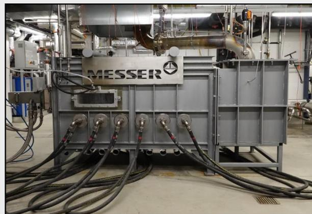
Abb.1: Brennkammer-Prüfstand im IWT-Labor
