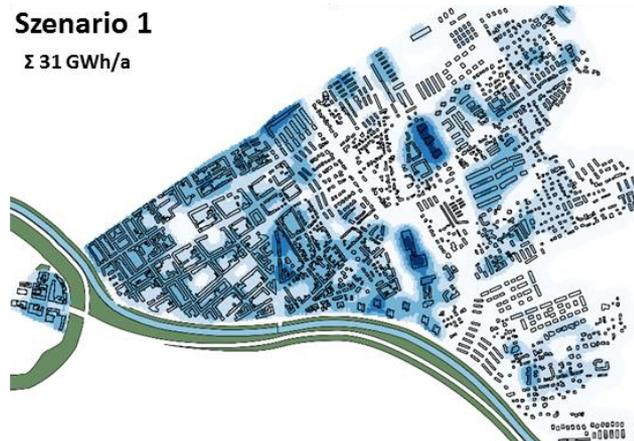
transiente, multisektorale Simulation – Darstellung spez. Heiz- und Kühlwärmebedarf
