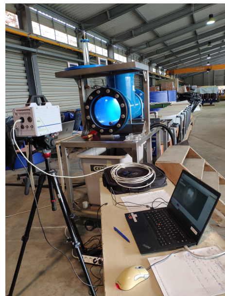
Bild 1: Schema der Barotraumakammer, Kammer mit Highspeedkamera im Wasserbaulabor der TU Graz
