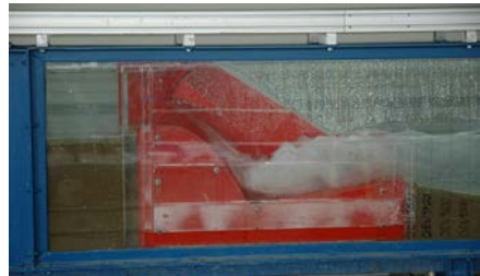
Ausbildung der Deckwalze | Formation of a standing surge
