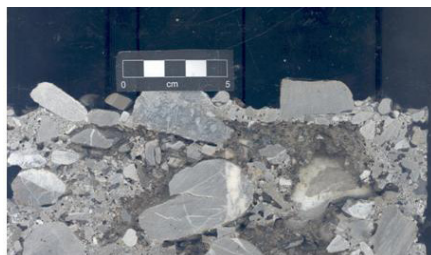
Kolmationsschicht im obersten Bereich der Sohle | Clogging of the upper part of the river bed
