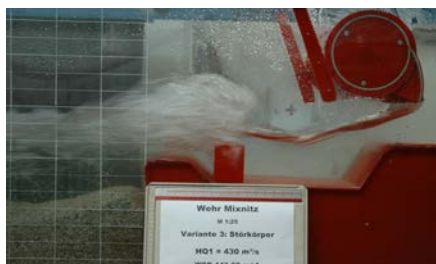
Modell mit Tosbeckenstörkörper | Model with energy dissipater in the stilling basin
