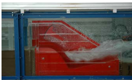
Ausbildung der Deckwalze | Formation of a standing surge
