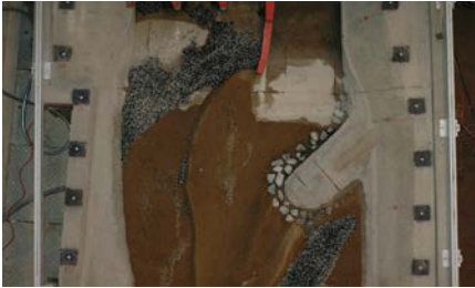
Variante mit Buhnen | Version with groins
