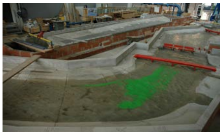
Geschiebeversuch | Bed load test
