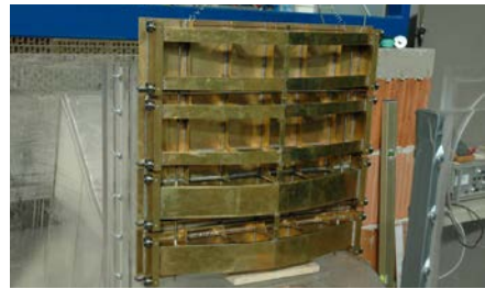
Dammbalken Modellausführung | Stop-log model design
