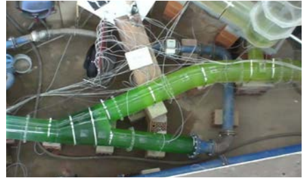
Kurzschlussbetrieb | Short circuit operation
