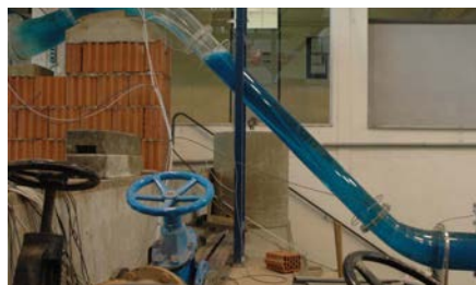
Teilgefüllter Verbiundgschacht | Partial filled connection shaft
