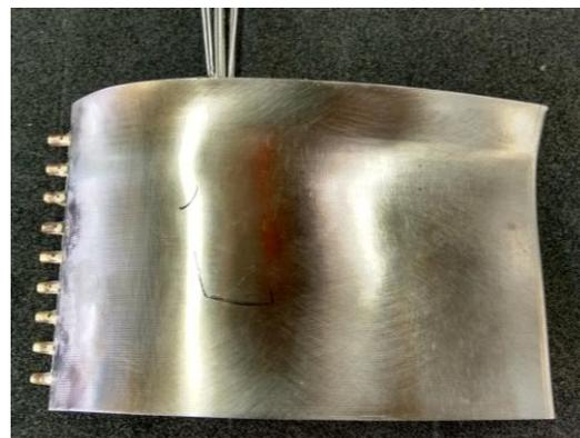
Turbinenschaufel mit Totaldrucksonden an Vorderkante
