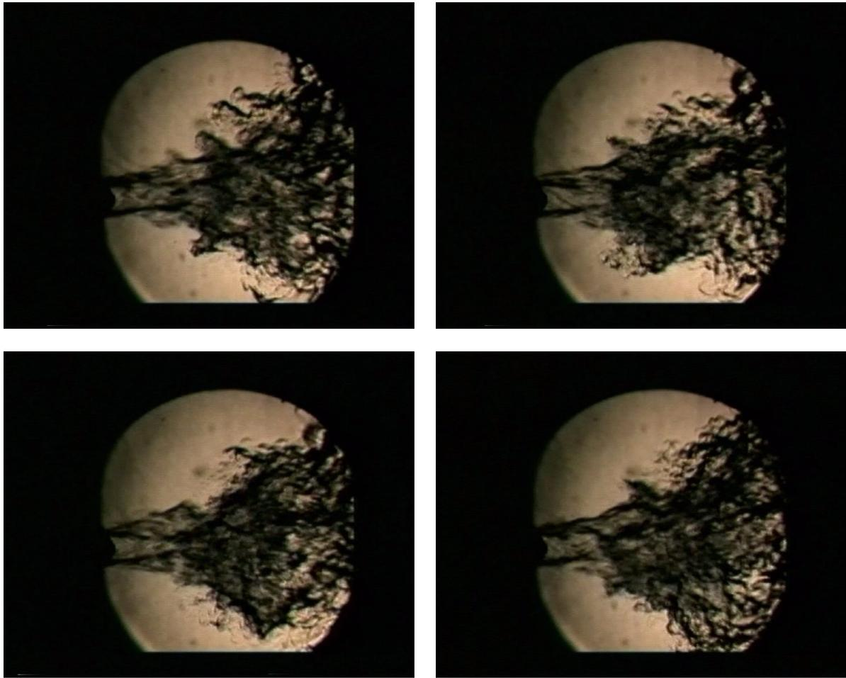
Abbildung 4.5: Beispiel einer kurzen Folge an Schlierenaufnahmen bei 50 Hz Pulsation. Zeitliche Laufrichtung von links oben nach rechts unten
