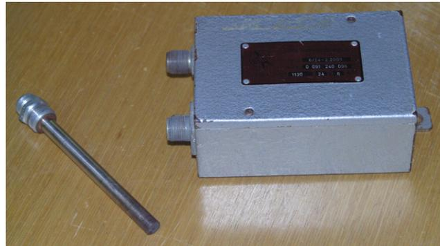
Abbildung 2.17: Zündkerze und Zündbox. Aus Gründen der Übersichtlichkeit wurde das Zündkabel entfernt.
