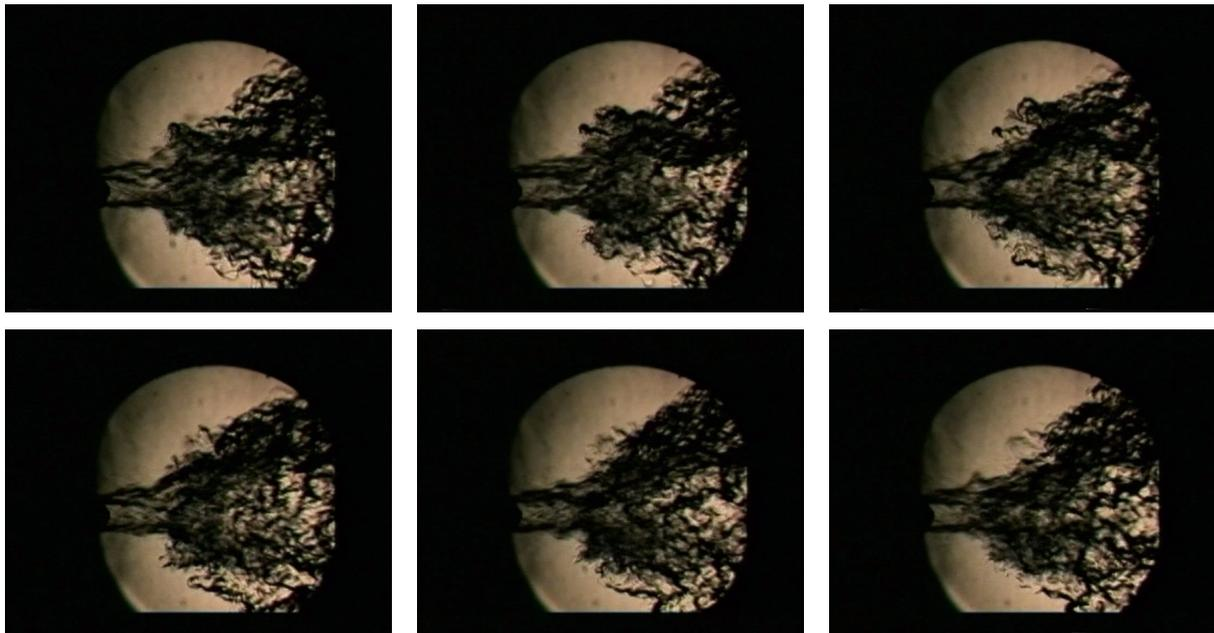
Abbildung 4.14: Schlierenaufnahmen der Flamme ohne Pulsation
