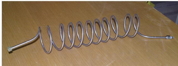
Abbildung 2.32: Zum Wärmetausch verwendete Leitungsspirale
