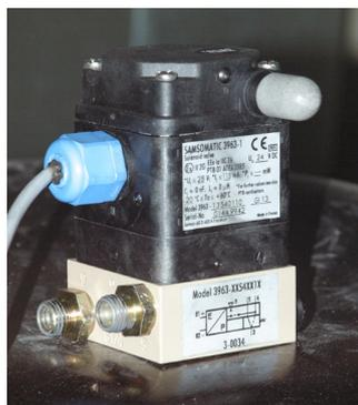
Abbildung 2.30: Magnetventil des Typs SAMSOMATIC 3963
