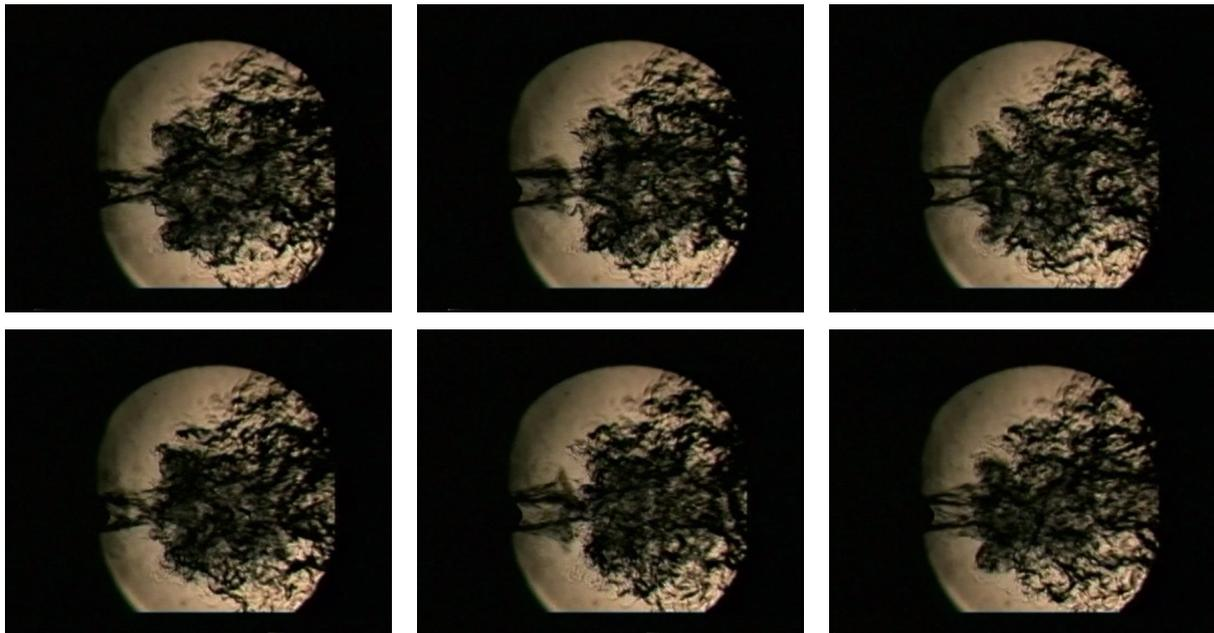
Abbildung 4.11: Schlierenaufnahmen der Pulsation bei 175 Hz
