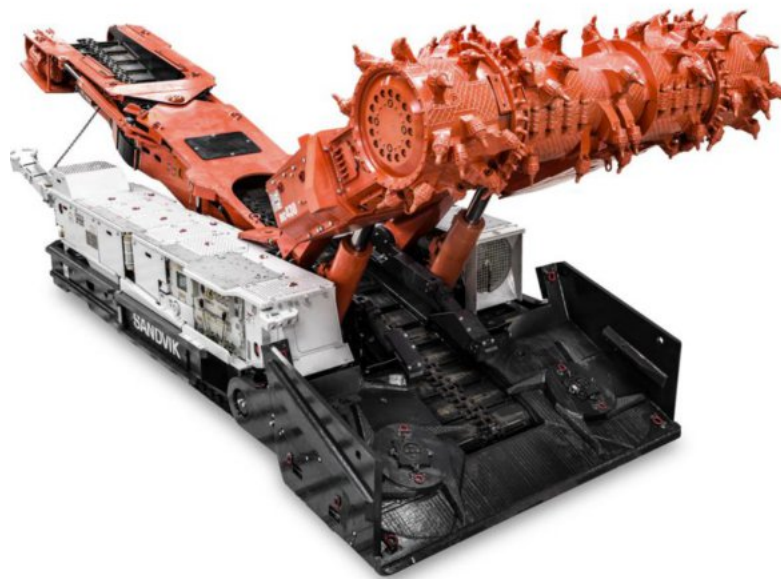
Abbildung 1. Exemplarische Gewinnungsmaschine mit Raupenfahrwerk
