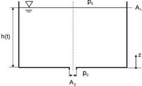
Der Ausfluss erfolgt durch eine kleine Öffnung (Fläche  $A_2$ ) im Boden. Die Rechnung soll quasistationär erfolgen, wobei der Anlaufvorgang unberücksichtigt bleiben soll. D. h., der Behälter wird rasch bis zur Höhe  $H$  gefüllt, wobei aber gleichzeitig Flüssigkeit durch die Austrittsöffnung treten kann.
