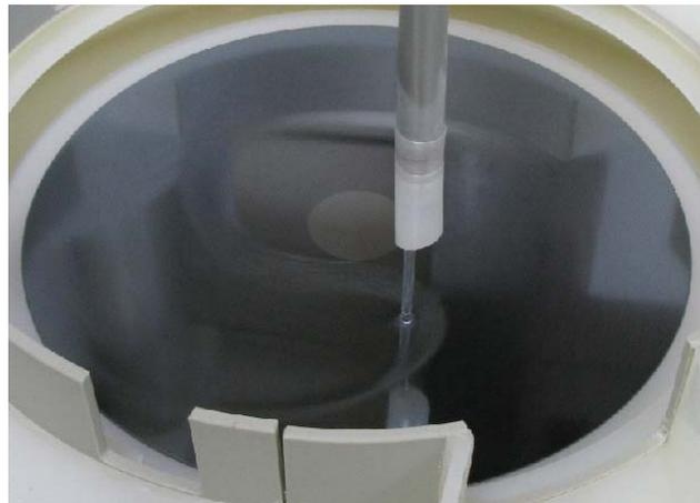
*Abb.1: Zentraler Filmaufbruch bei exzentrischem Auftrag*
