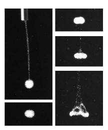
die Ermittlung von günstigen Kombinationen der Betriebsparameter des Tropfengenerators, die die Erzeugung von Tropfen mit möglichst genauer anfänglicher Kugelform ermöglichen. Dies ist besonders kritisch für große Volumenkonzentrationen und geringe Tropfendurchmesser. Weiterhin soll das Funktionieren der digitalen Bildverarbeitung hinsichtlich der Bestimmung von Tropfenposition, -größe und Teilchenanzahl überprüft und bei Bedarf verbessert werden.
