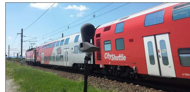
Abb. 2: Kunstkopf bei einer on-site Messung in Deutsch-Wagram
