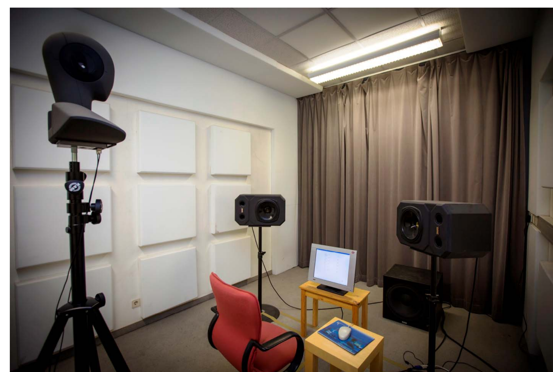
Reflexionsarmer Laborraum für Hörversuche am ISV
