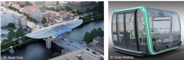
Abb. 1: Haltestelle Bertha-von-Suttner-Brücke und Kabine einer 3-S-Seilbahn (35 Personen)
