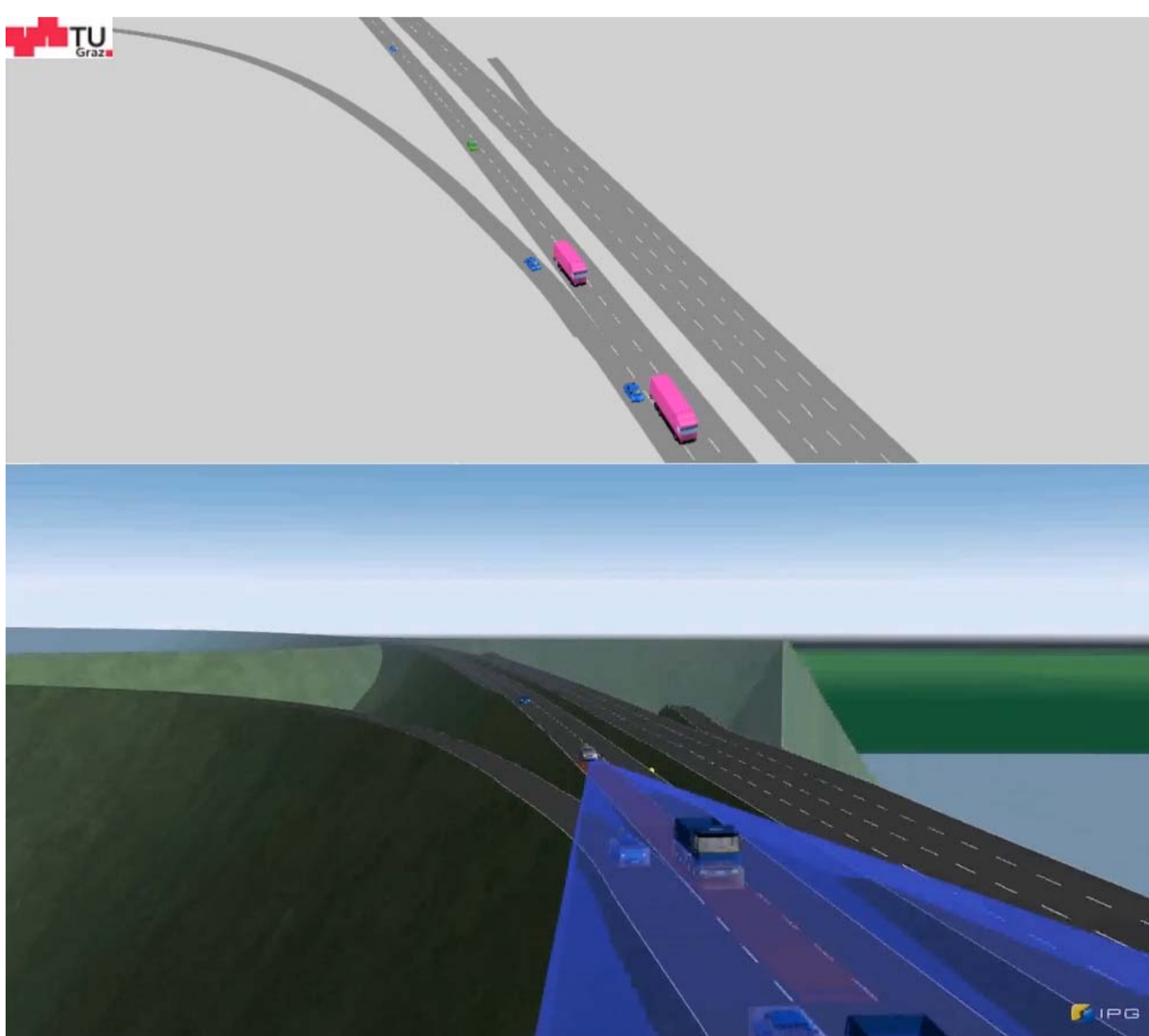
Abb. 2: Co-Simulation zwischen PTV VISSIM (mikroskopische Verkehrsflusssimulation) und IPG CarMaker (Fahrzeugsimulation)
