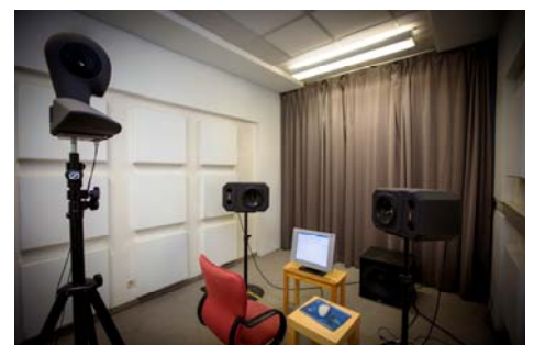
Reflexionsarmer Raum für Hörversuche am ISV
